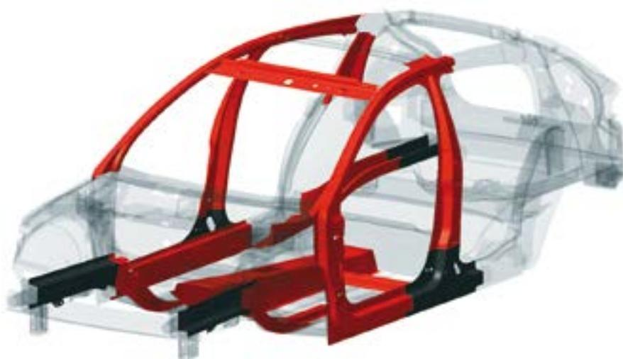
Zur Erhöhung der Sicherheit werden in Autokarosserien formgehärtete Komponenten eingesetzt: weichere Bauteile zur Absorption der Aufprallenergie (schwarz) und steife Bauteile für eine stabile Fahrgastzelle (rot).
