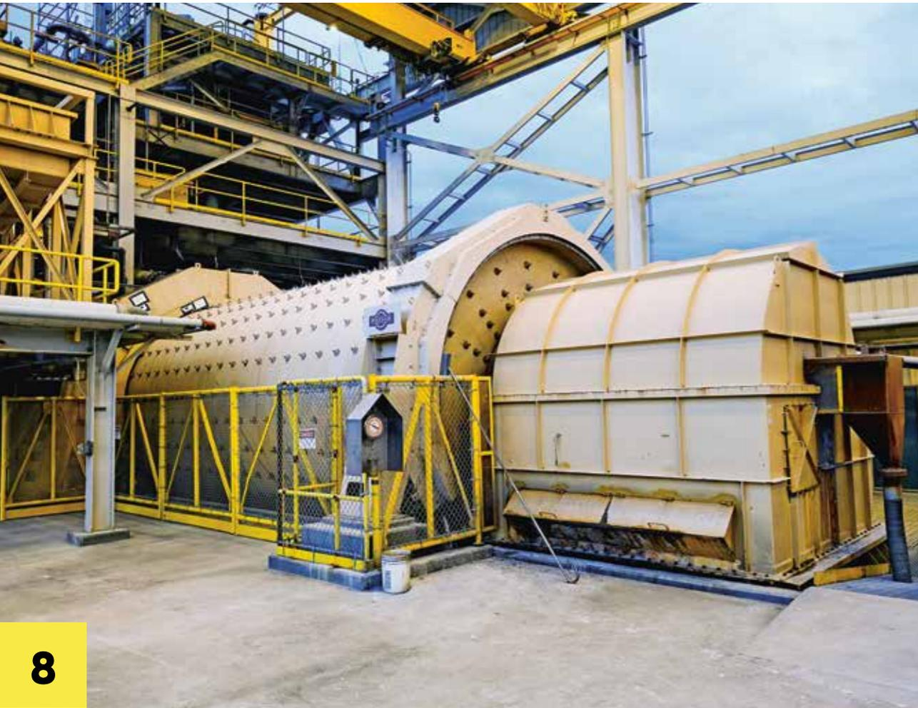
Die Trommel der Kugelmühle ist so hoch wie ein Haus. Sie rotiert in nur wenigen Sekunden einmal um die eigene Achse.
