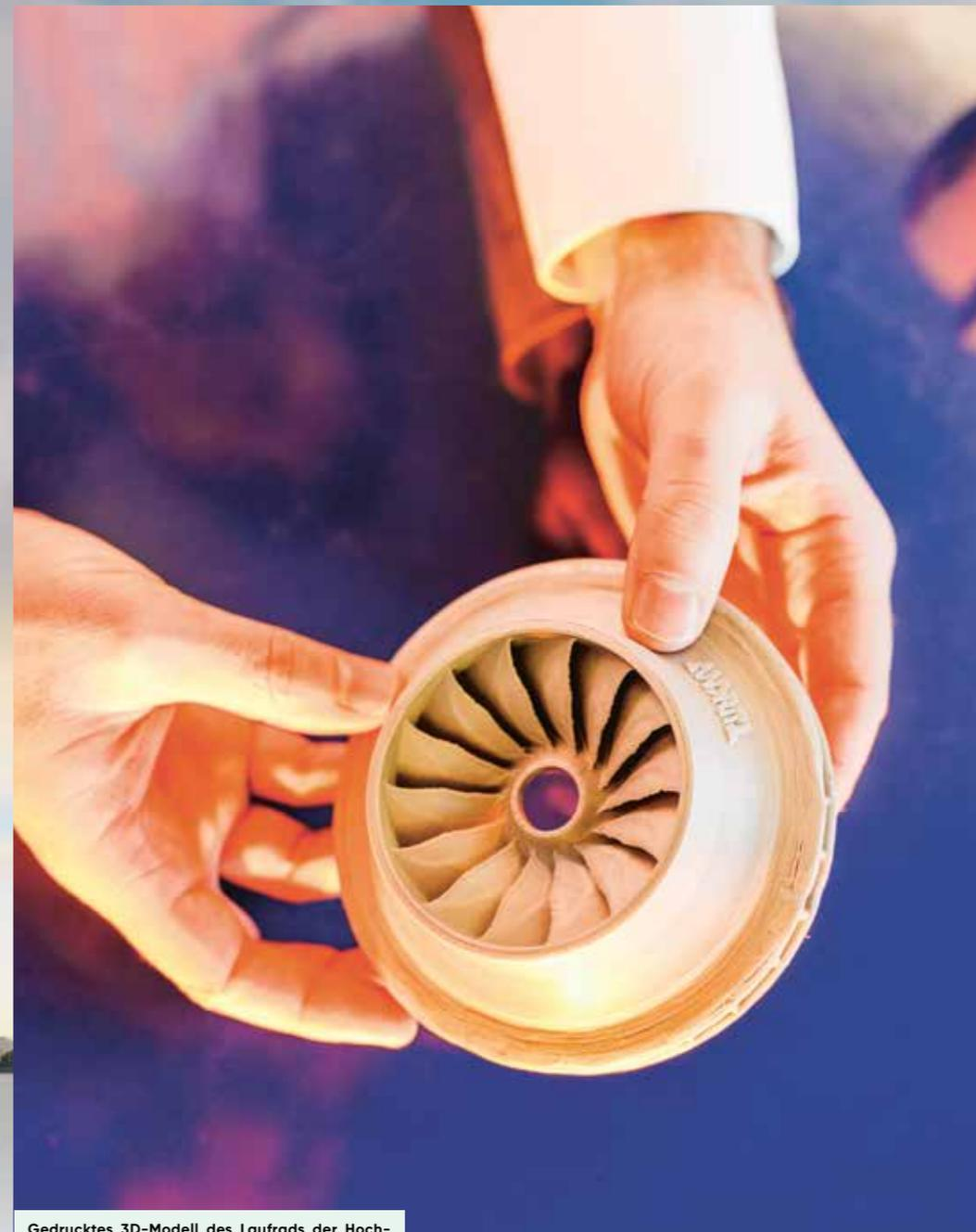
Gedrucktes 3D-Modell des Laufrads der Hochdruck-Francis turbine, die bei Lysebotn installiert wurde. In Wirklichkeit beträgt der Durchmesser 1.475 Millimeter.
