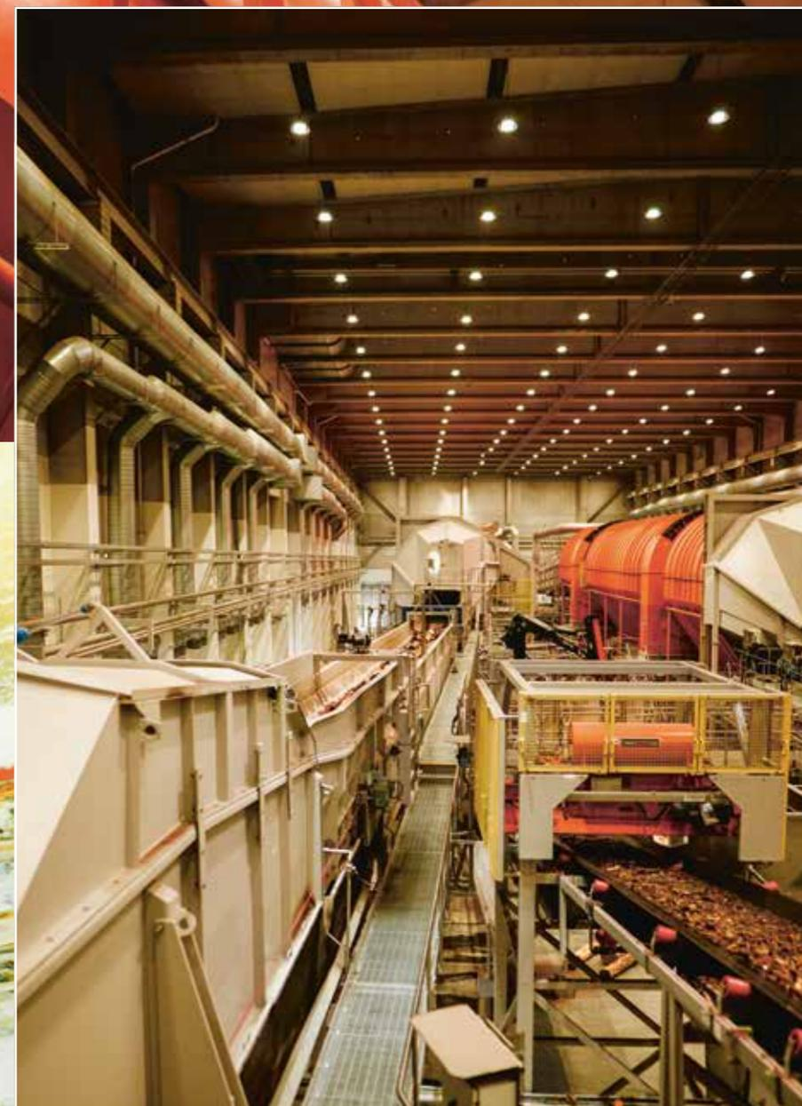
Kompletter Holzplatz mit zwei parallel angeordneten Entrindungs- und Hackschnitzellinien sowie Rindenverarbeitung mit zwei HQ-Press-Rindenpressen für einen ausgezeichneten Rindentrockengehalt. Der Hackschnitzeltransport wurde umfangreich modernisiert.
