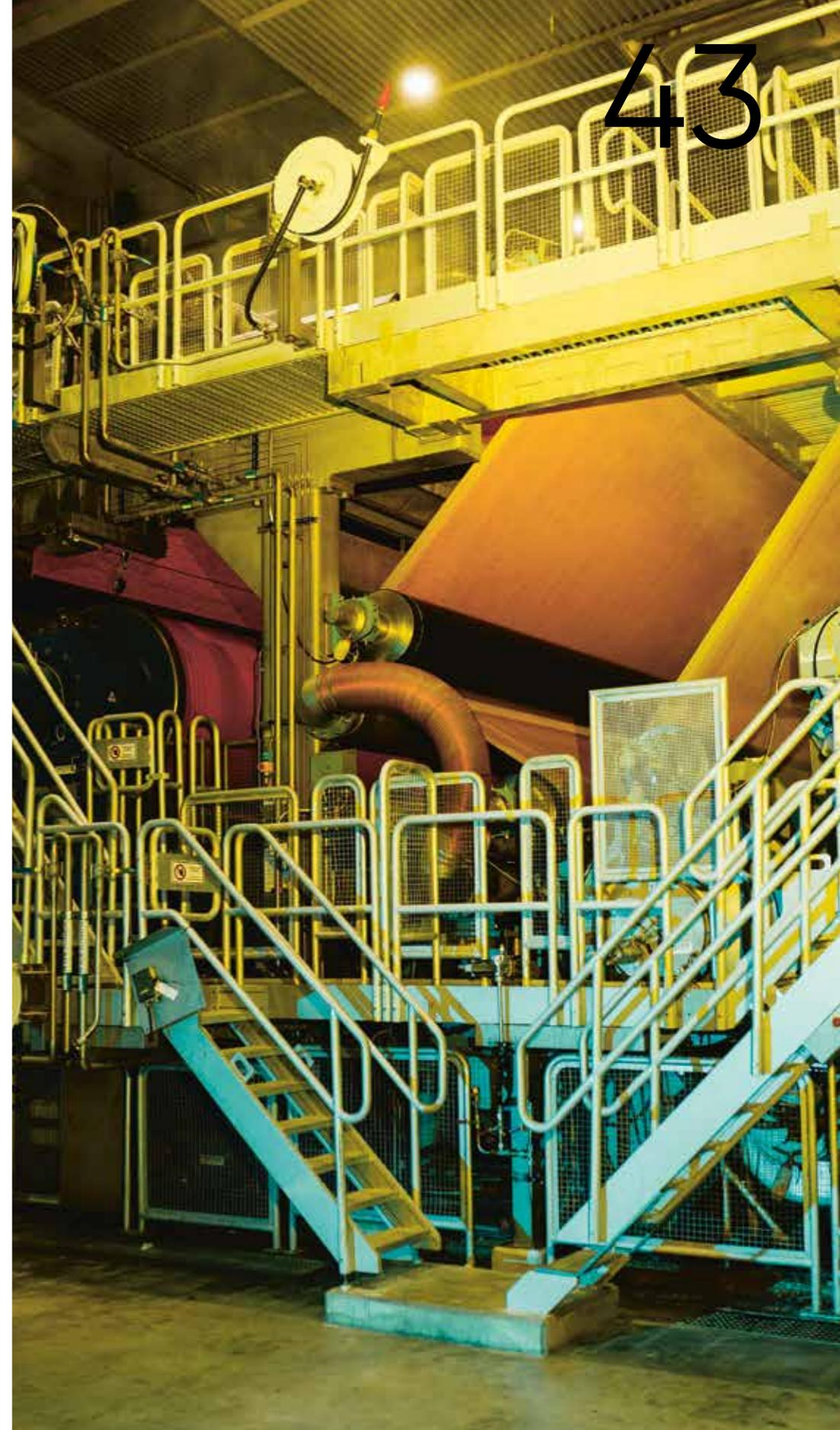
EvoDry™-Zellstofftrocknungssystem von ANDRITZ mit energiesparenden Technologien, die die Betriebskosten des Werks deutlich senken. Das System enthält eine Energierückgewinnung aus der Kesselabwärme, eine Feinsortierung sowie ein Doppelsiebentwässerungssystem mit vollautomatischer Bahnüberführung, das strengste Gesundheits-, Sicherheits- und Umweltvorschriften erfüllt.
