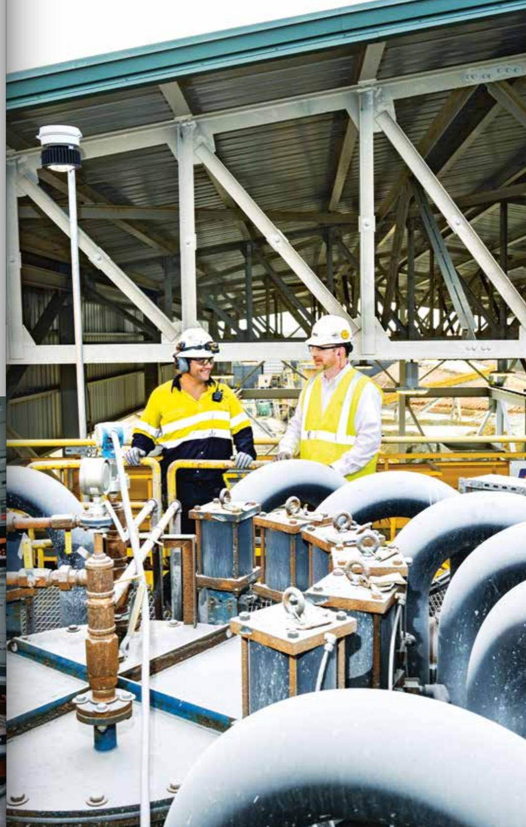
Anderson und Schug an einem der Hydrozyklone im Mahlbereich, in denen mit einem physikalisch-chemischen Verfahren das Erz aufbereitet wird.
