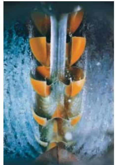
Wasserstrahl beim Eintritt in das Laufrad einer Compact Pelton Turbine
