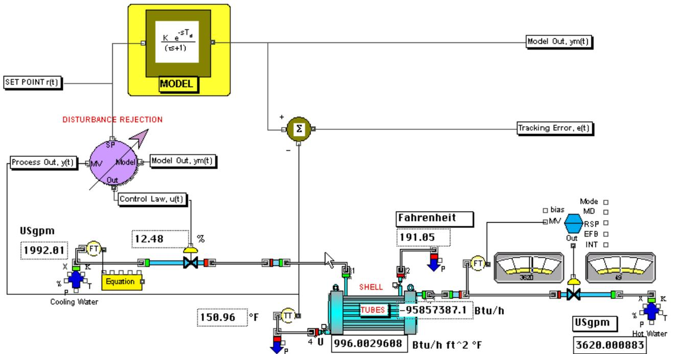
**FIG 3. ADAPTIVE TEMPERATURE CONTROL DIAGRAM**
