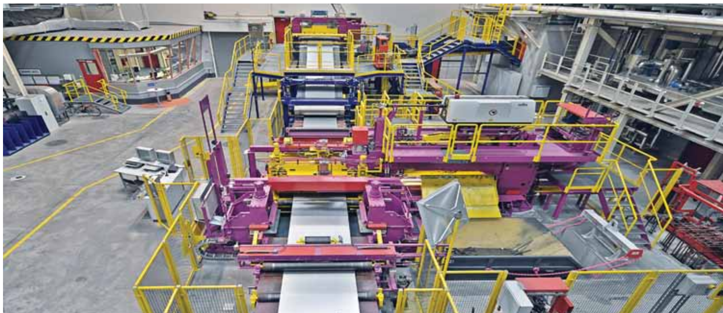
▲ Einlauf mit Laserschweißmaschine
