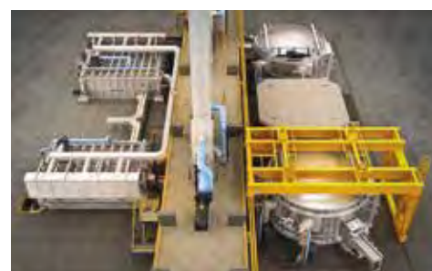
▲ 保温炉倾动精确控制铸造流槽液面
