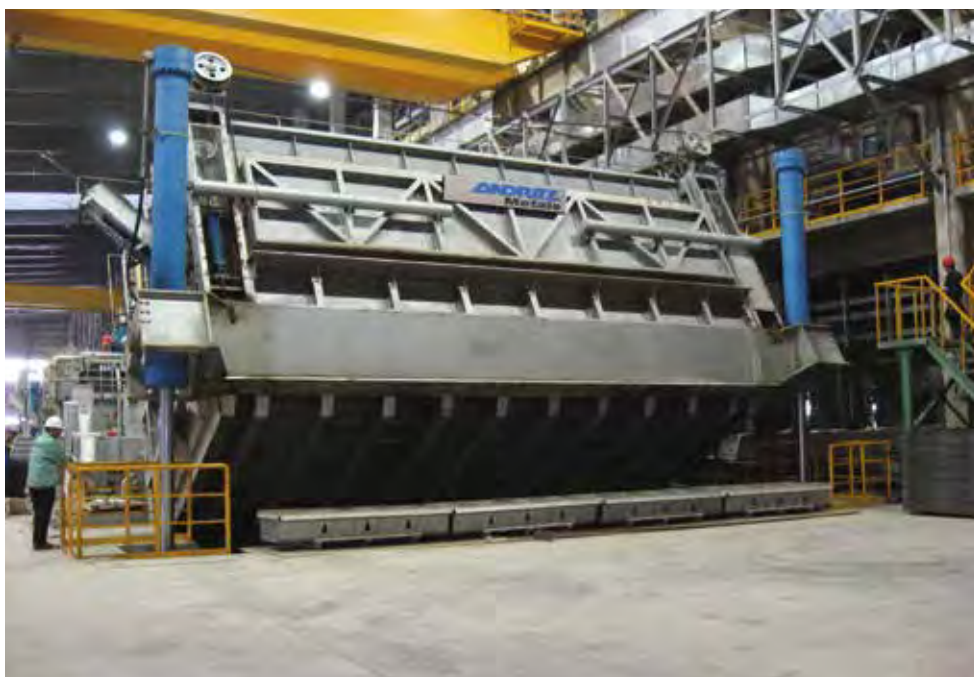
▲ 保温炉倾动精确控制铸造流槽液面
