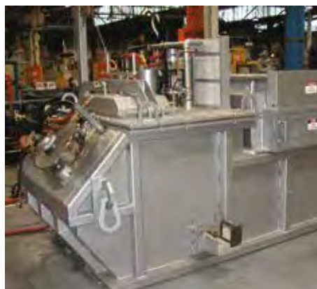
▲ Elektrisch beheizter Präzisions-Dosierofen
