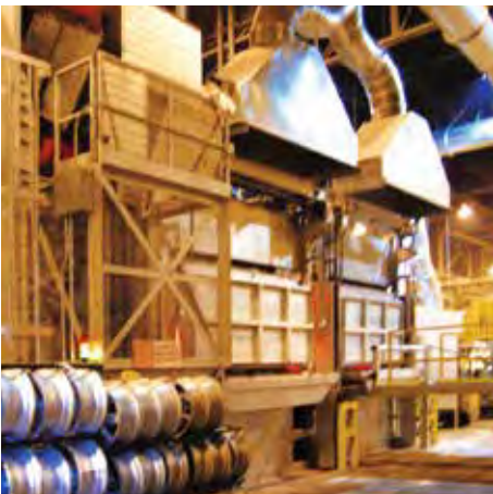
▲ Schachtschmelzofen mit einer Kapazität von 4.200 kg/h mit optionaler Späne Tasche
