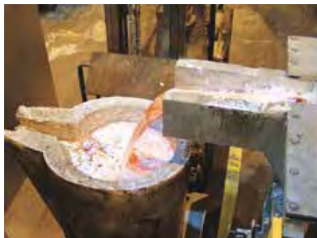
▲ Automatische Entnahme des Flüssigmetalls
