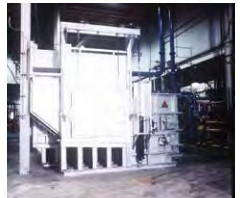
▲ Schmelzofen mit einer Schmelzleistung von 1.000 kg/h
