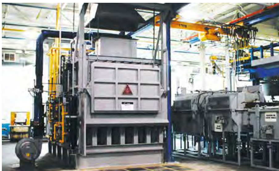
▲ Ein großer Hersteller von Innenbord- und Außenbordmotoren für den Marinebereich nutzt die voll integrierte HITEQ Lösung: Schmelzen von Aluminium, Behandlung, Zuführung und Warmhalten für das Lost-Foam-Motorblockgießen.
