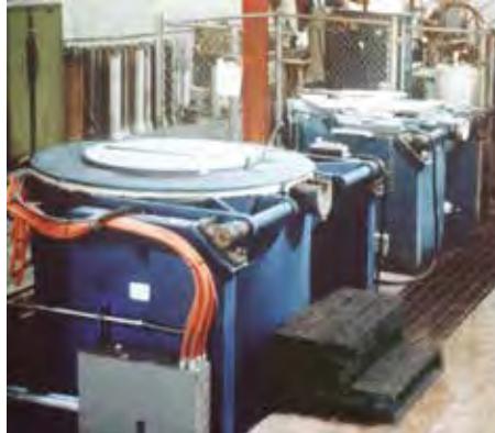
▲ Elektrisch beheizter Tiegelofen mit einer Kapazität von 900 kg/h
