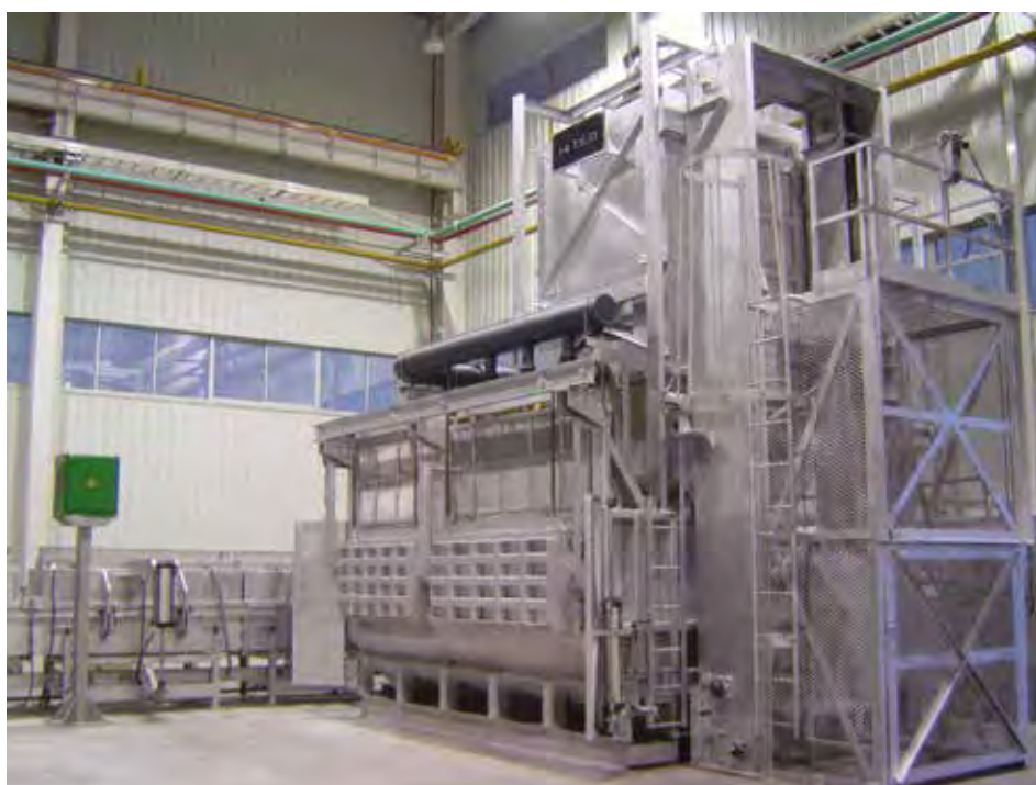
▲ Schachtschmelzofen mit einer Schmelzleistung von 1.500 kg/h
