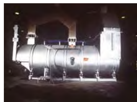
▲ Trommelkipföfen mit einer Schmelzleistung von 2.200 kg/h
