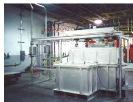
▲ Elektrisch beheizter Filterofen mit automatisch öffnenden Türen
