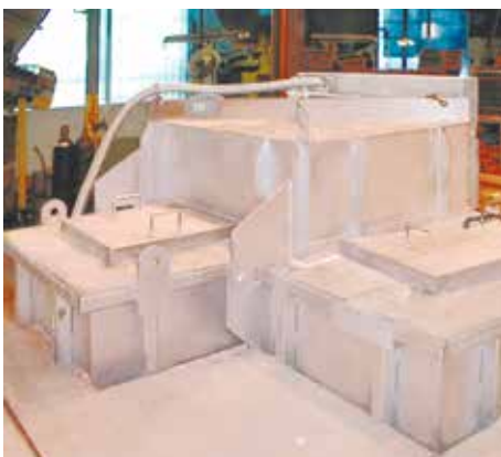
▲ Elektrischer Schmelzofen mit einer Kapazität von 900 kg/h
