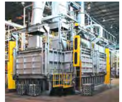
▲ Gasbefeuerter Schmelzofen mit Regenerativbrennern
