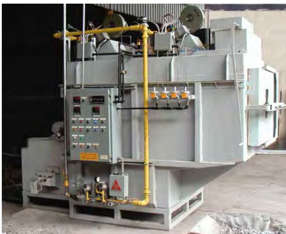
▲ MiniMelter mit einer Schmelzleistung von 180 kg/h
