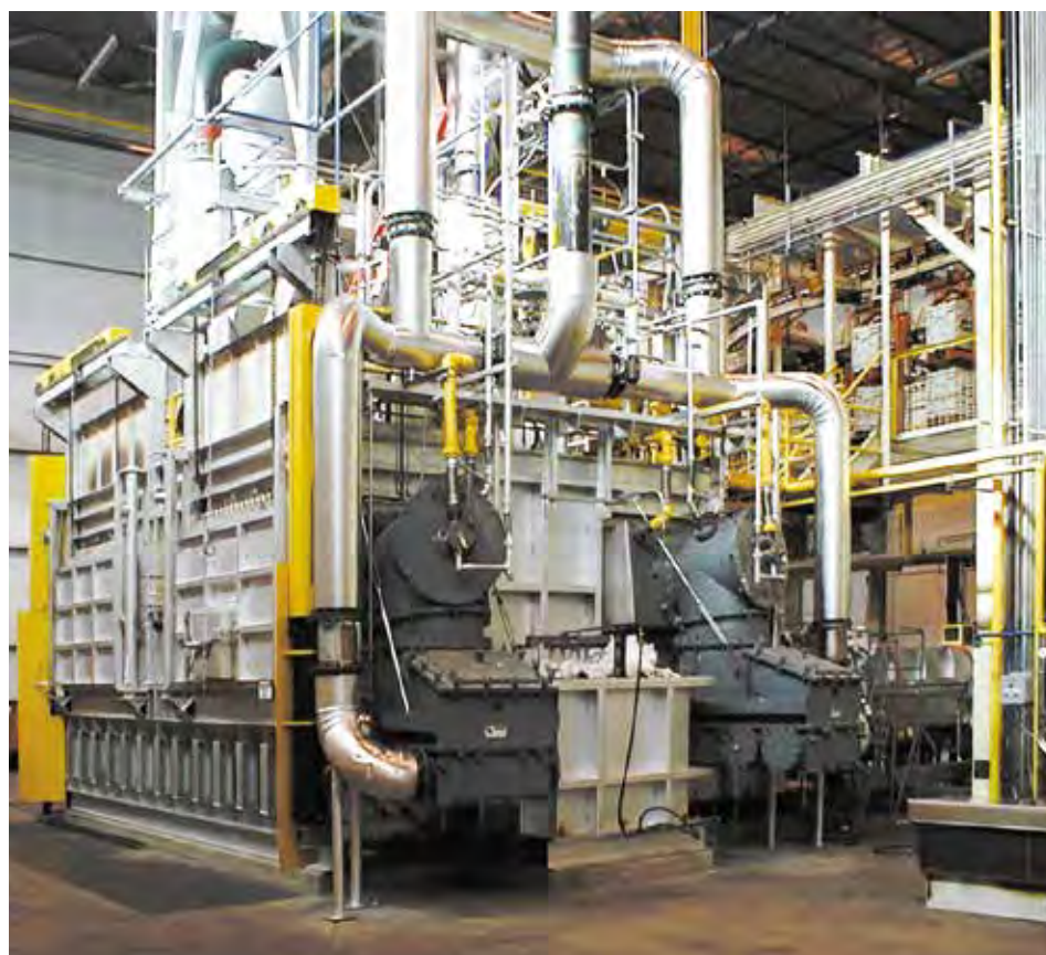
▲ Regenerativer Badofen mit einer Kapazität von 4.550 kg/h
