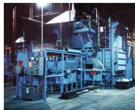
▲ Bad- und Späneschmelzofen mit einer Schmelzleistung von 1.500 kg/h
