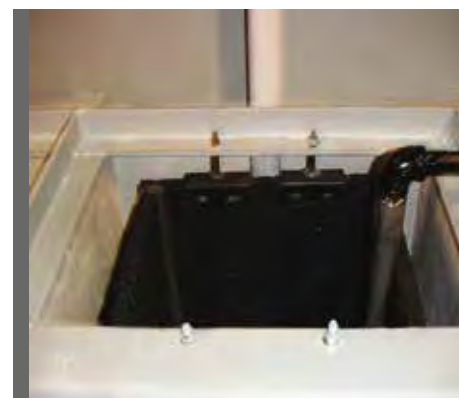
▲ Entgasungsstation und Filtereinheit
