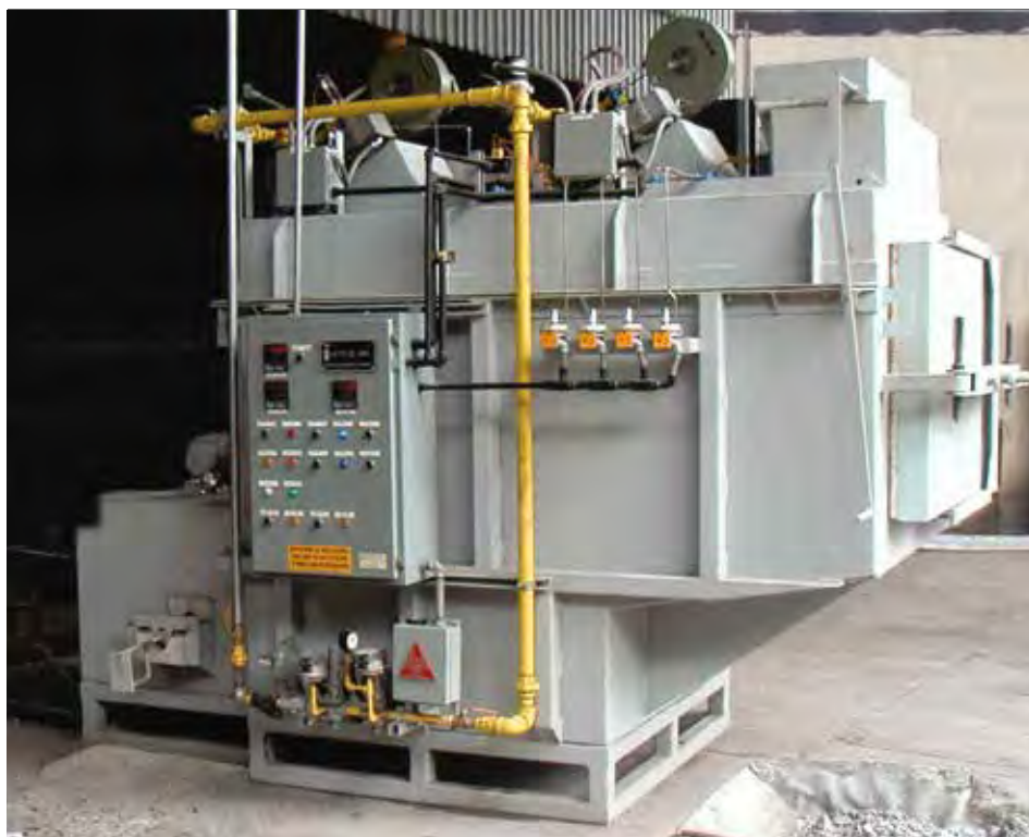
▲ 熔化速率为 180 kg/hr 的微型熔化炉
