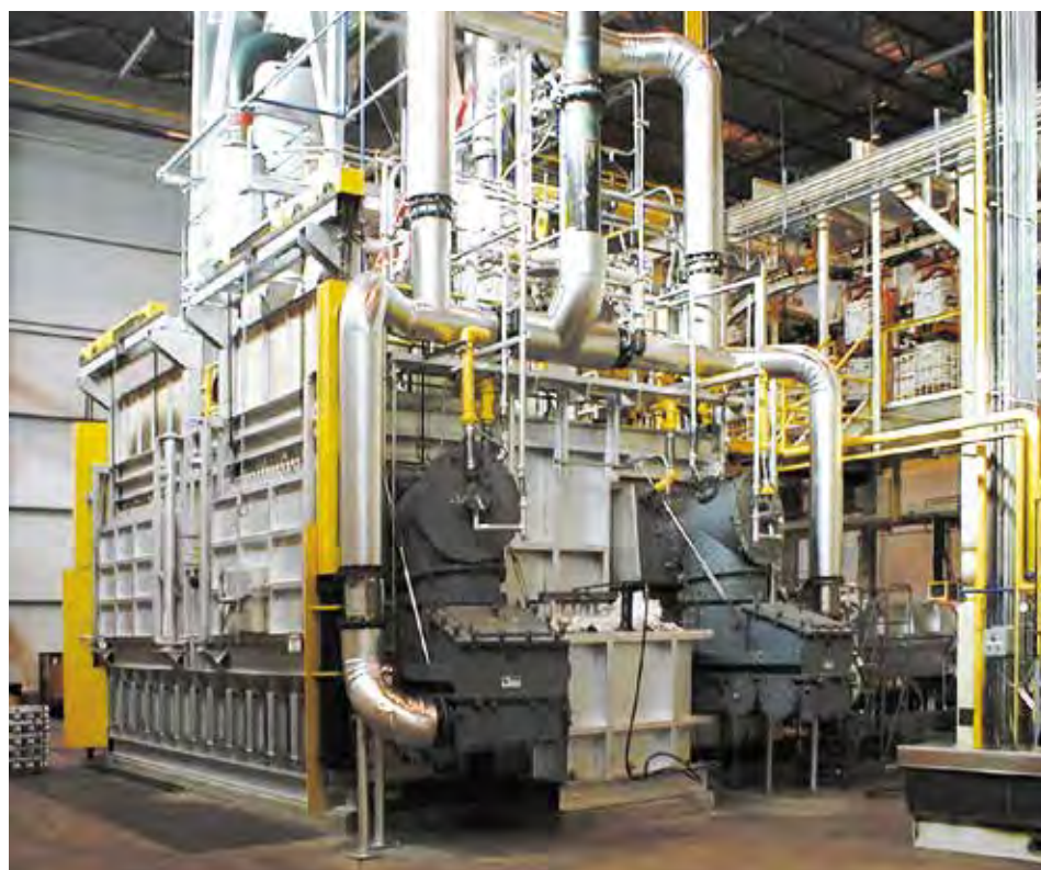
▲ 蓄热式反射炉 熔化速率 4,550 kg/hr
