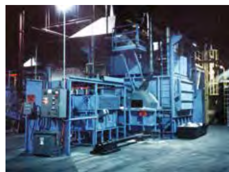
▲ 铝屑熔炼炉 熔化速率 1,500 kg/hr
