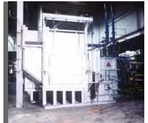
▲ 干式炉膛熔炼炉 熔化速率 1,000 kg/hr
