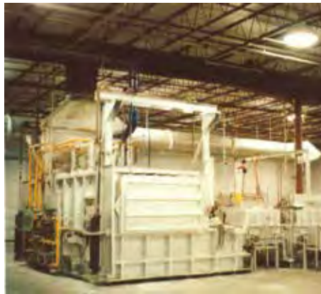
▲ 铝熔炼、输送、处理和保温线包括煤气反射熔炼炉和塔式进料炉，用于对回炉料和废料进行高效熔炼。
