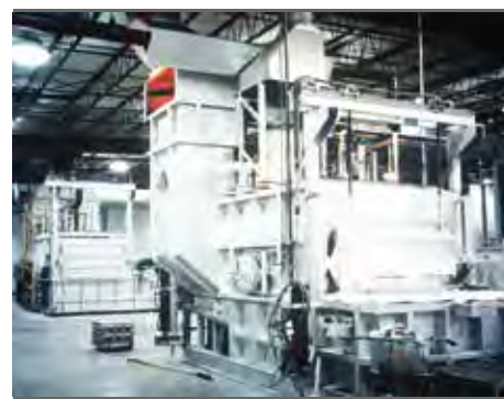
▲ 顶辐射熔池反射炉 熔化速率 1,200 kg/hr
