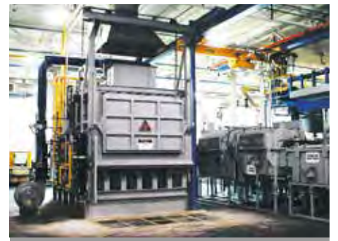
▲ 熔铝反射炉 熔化速率 1,800 kg/hr
