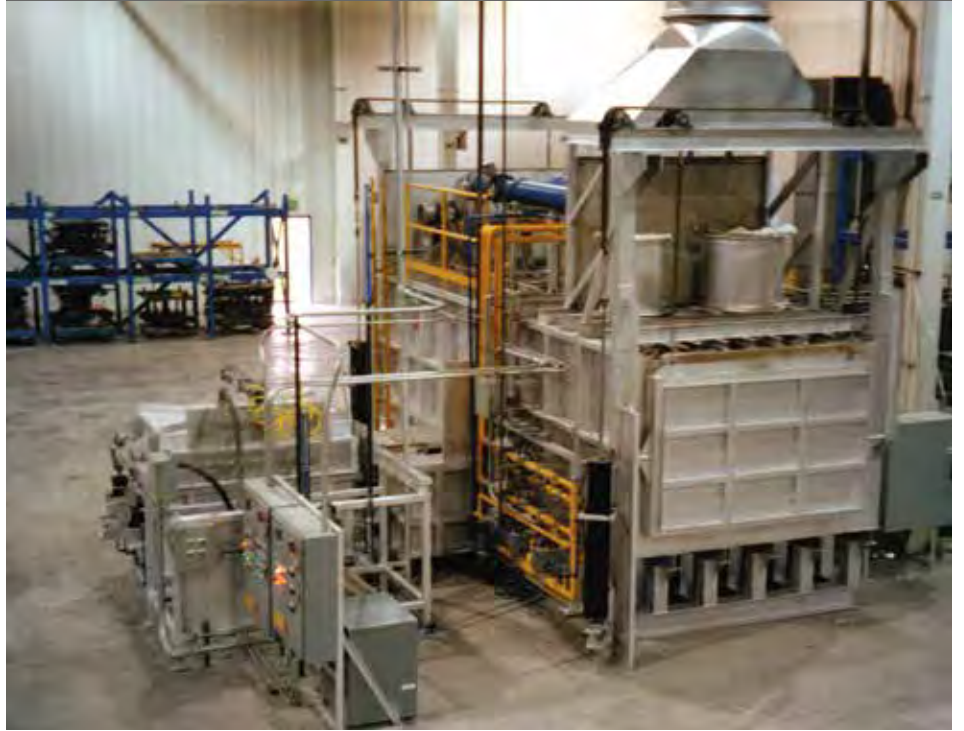
▲ 干式炉膛熔铝炉 带过滤装置 熔化速率 1,800 kg/hr
