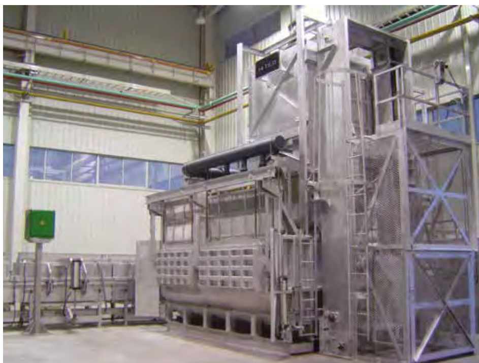
▲顶装料熔铝炉 熔化速率为 1,500 kg/hr
