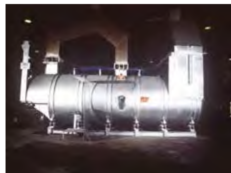
▲ 高速圆桶型倾动熔铝炉 熔化速率 2,200 kg/hr
