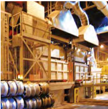
▲ 带铝屑熔化选项的顶装料熔铝炉，熔化速率 4,200 kg/hr
