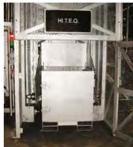
▲采用 PLC 控制的装料框
