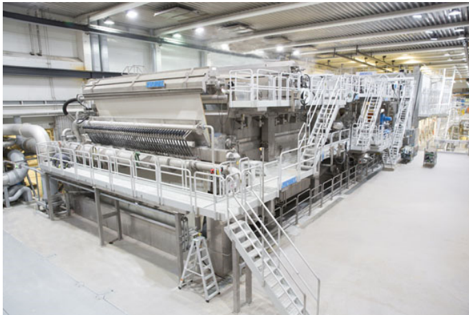
ANDRITZ-Zellstoffrocknungslinie.
