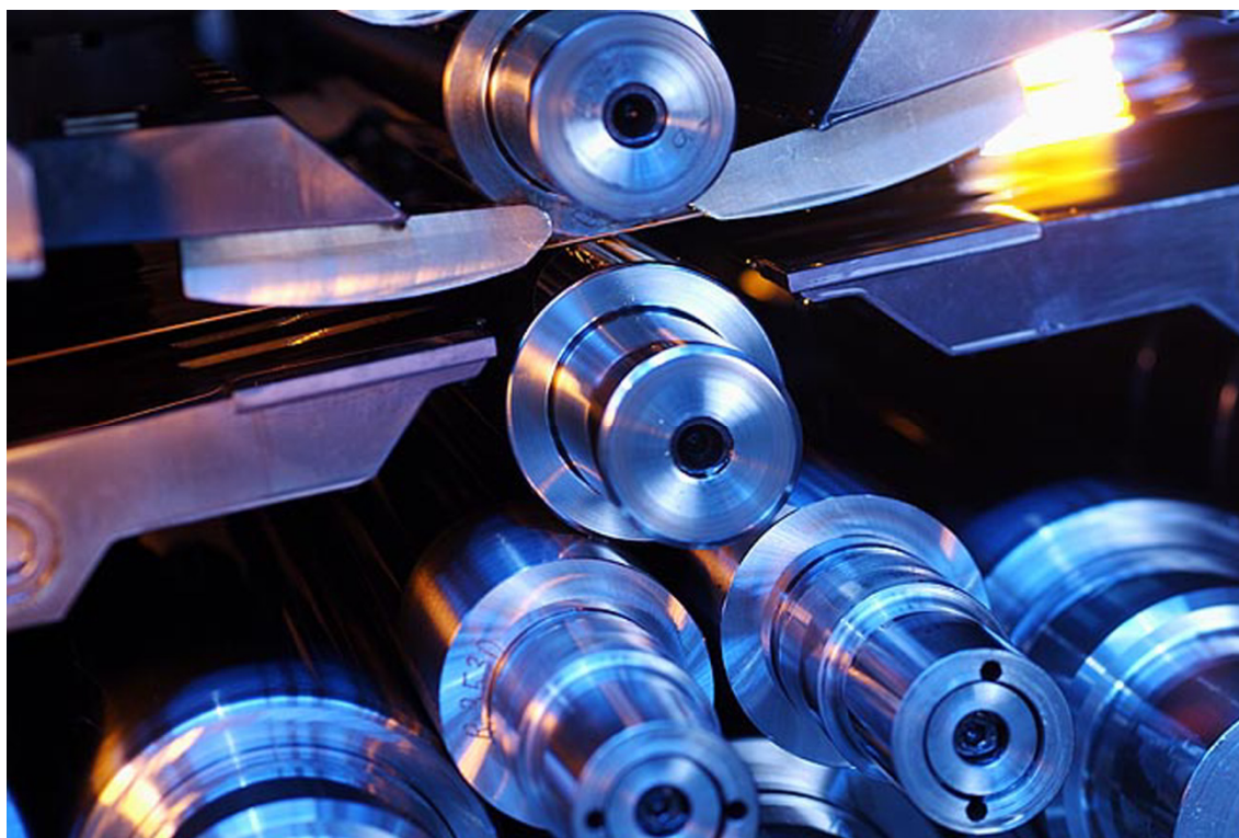
Detailansicht des ANDRITZ-20-Rollen-Kaltwalzwerks.
