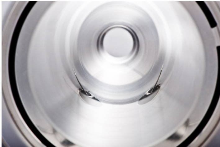
Detail eines Waschwasserzyklons zur Reduktion von Quecksilber (patentiert von ANDRITZ)
