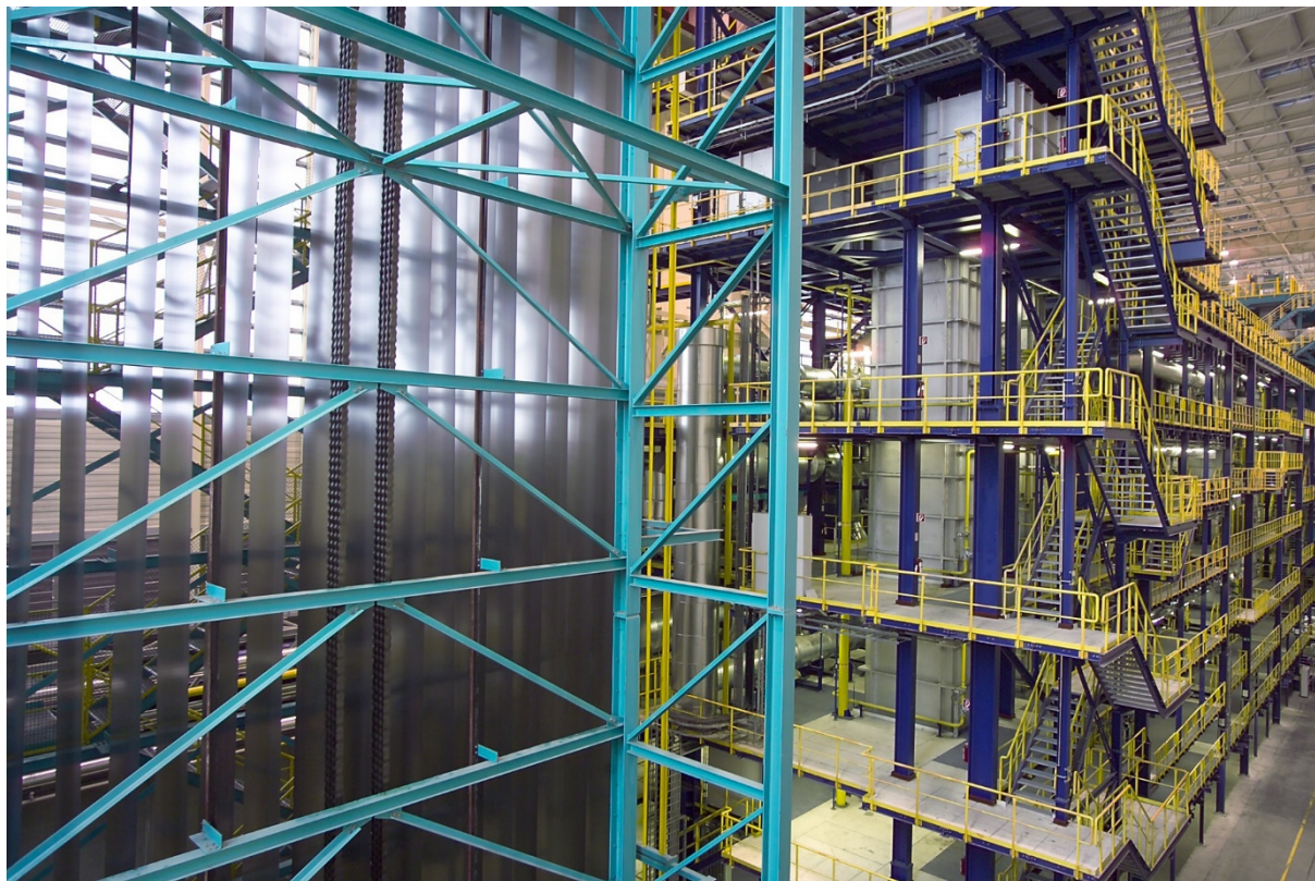
ANDRITZ Einlaufbandspeicher und Glühofen
