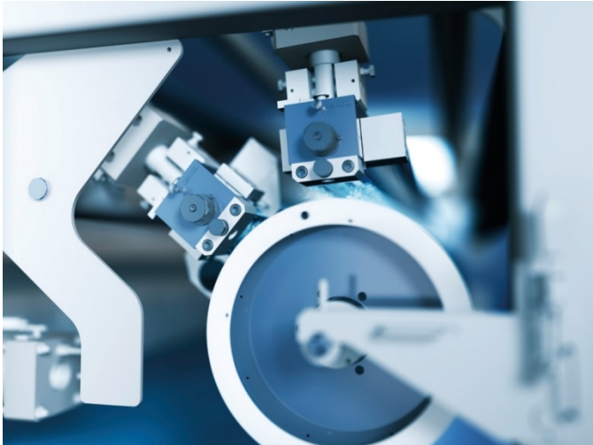
ANDRITZ neXjet-Injektor für die Wasserstrahlverfestigungsmaschine.
