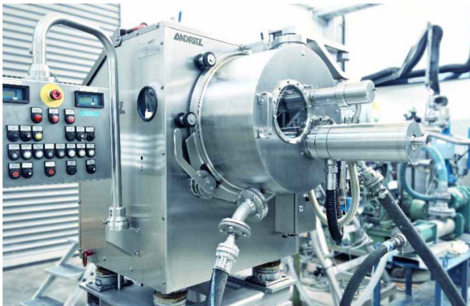
Krauss-Maffei-Schälzentrifuge mit dem vor kurzem präsentierten, pneumatischen Austragssystem.
