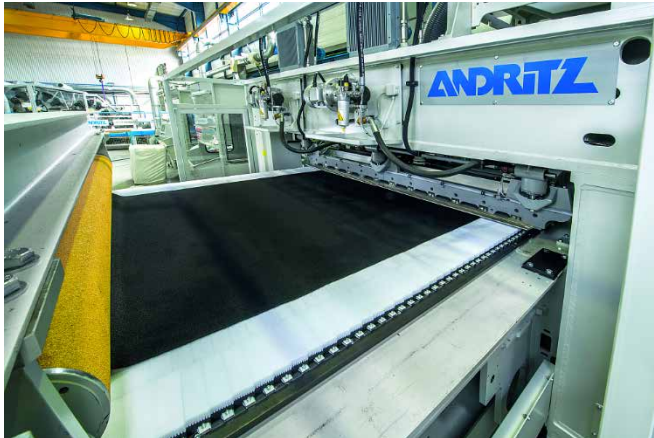
ANDRITZ-Nadelmaschine für Velours für die Automobilindustrie.
