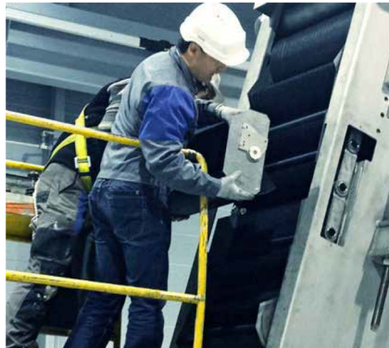
Aqua-Screen P und T: Der Filtereinsatz kann in weniger als 30 Minuten vom Vorderteil abmontiert werden.
