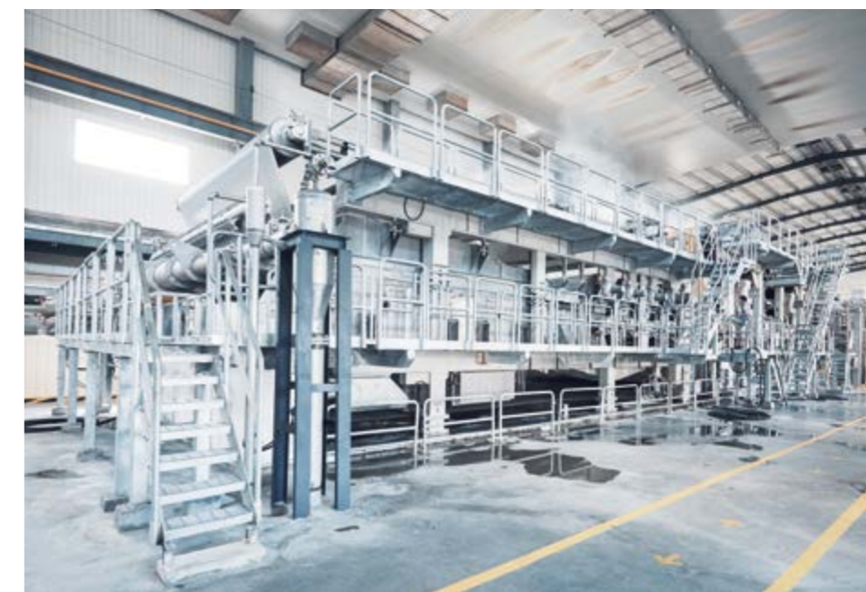
Линия сушки целлюлозы состоит из прессплат TwinWire, воздушной суши, резки с самоукладкой и системы конечной обработки кип.
