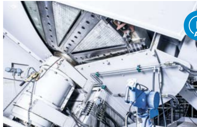
Рубительная машина HHQ-Chipper оснащена проверенной системой ножей TurnKnife TK-IV в комплекте с гидравлическим механизмом QuickClamp, позволяющим производить быстрые и безопасные замены ножей.
