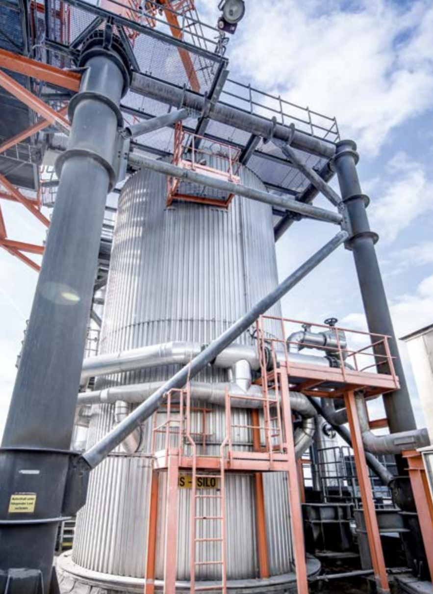
Модифицированная система вывода HELP™ с центральной пропаркой показала отличный результат в процессе пропитки.
