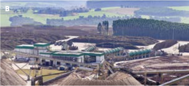
А Цех белого щёлока, поставленный компанией ANDRITZ для целлюлозного комбината Клабин в Ортигейра, Парана, Бразилия, имеет самую большую в мире систему каустизации, которая производит 16 000 м³ белого щёлока в день. В В 2016 году компания ANDRITZ поставила четыре окорочные и рубительные линии для ДПЦ, каждая из которых достигла рекордной производительности при запуске.
