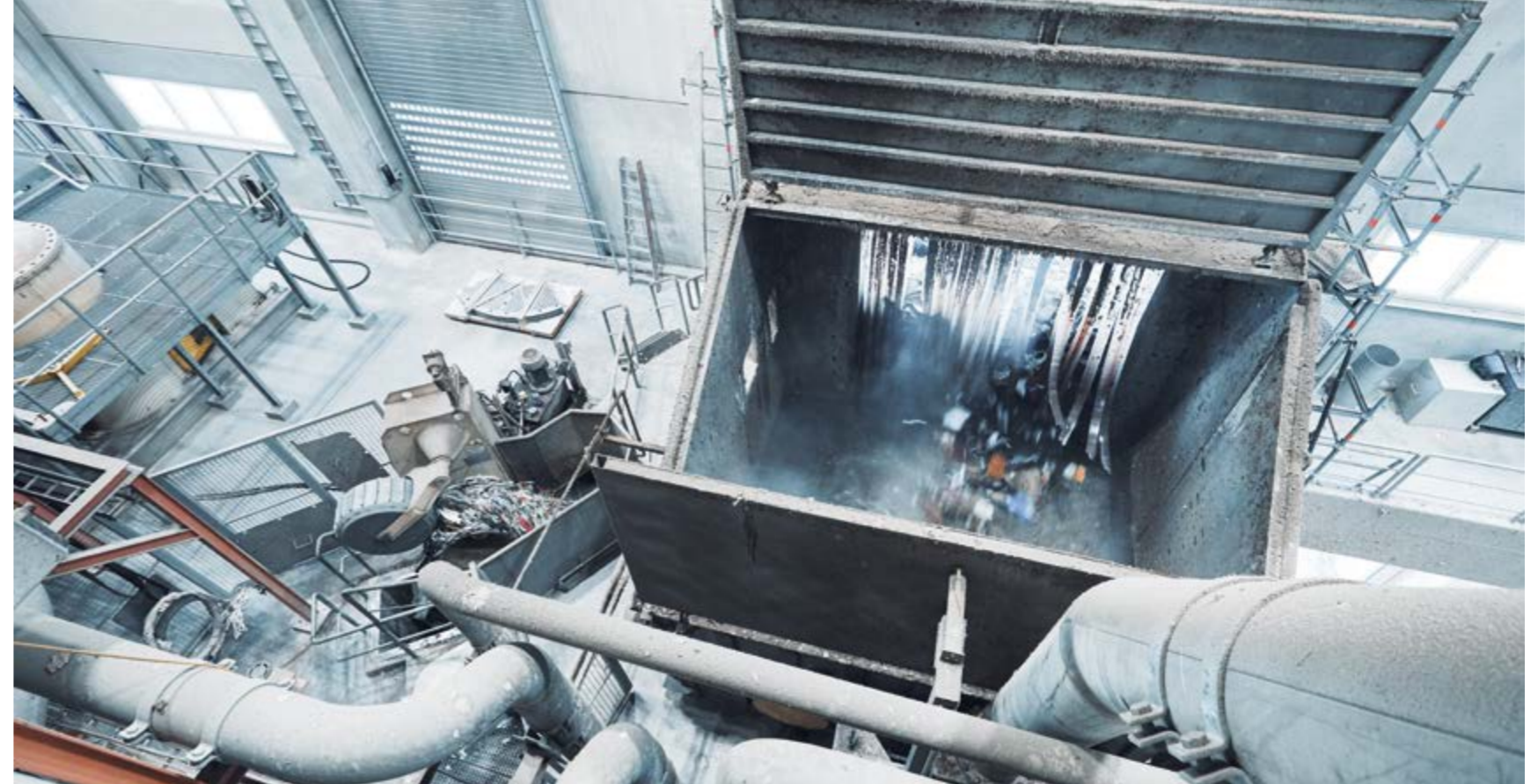
Предыдущие размольные устройства были адаптированы к линии RCF производительностью 1 350 тонн в день. Гидроразбиватель ANDRITZ FibreSolve FSR с системой утилизации обеспечивает оптимальную степень размола сырьевого материала.
