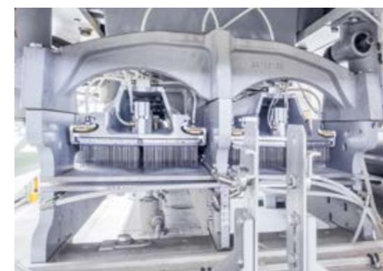
Иглопробивные станки: пневматическая централизованная система фиксации игольной доски
