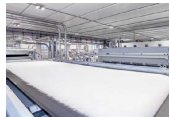
Профильный преобразователь прочёса с системами ProDyn и Isolayer для улучшения равномерности веса
