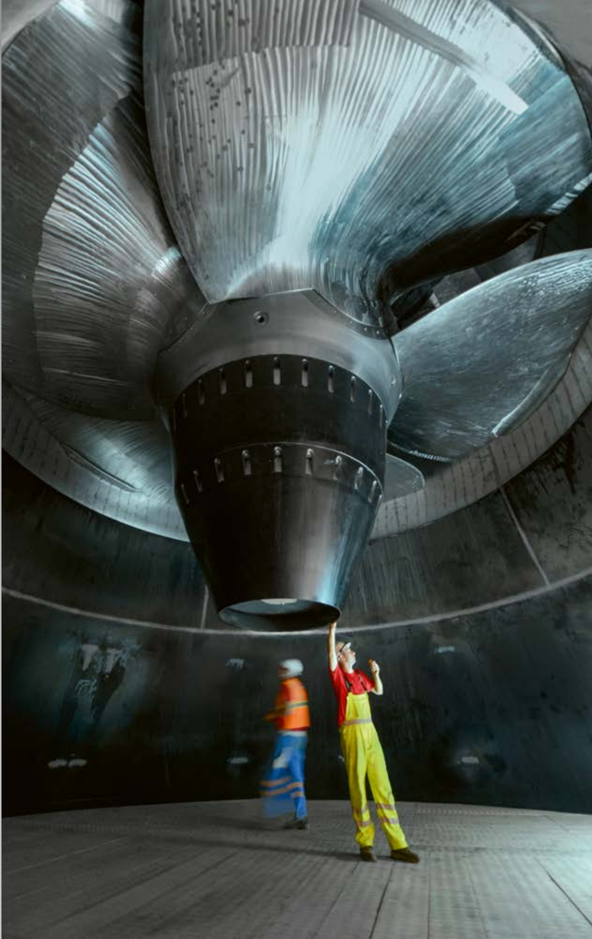
Made by ANDRITZ: Eine von sieben Kaplan-Turbinen, die im Xayaburi-Kraftwerk zusammen mehrere Millionen Haushalte mit Öko-Strom versorgen.
