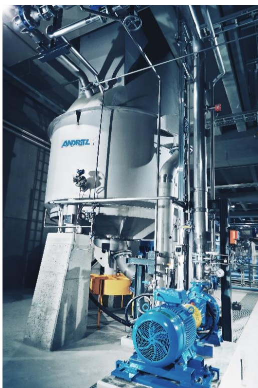
低浓碎浆系统的组成部分FibreSolve FSV碎浆机
