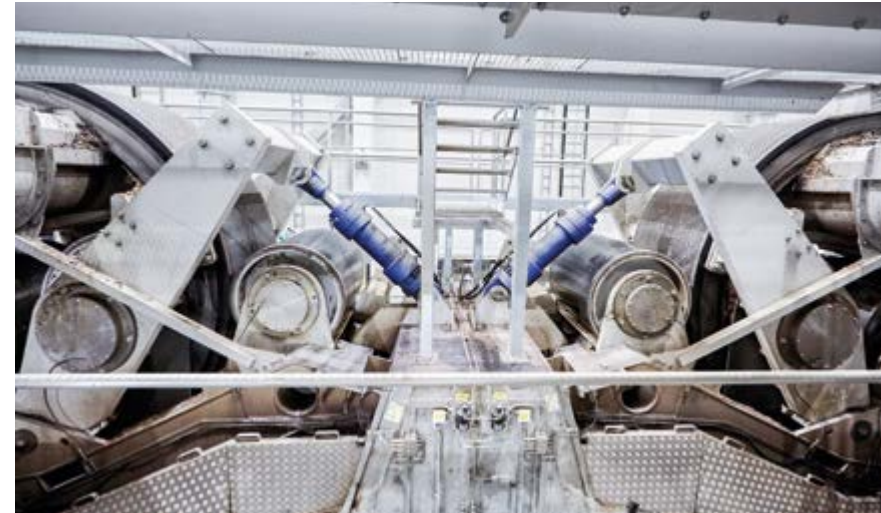
备木站两台新一代HQ-Press树皮挤压脱水机可提高树皮的热值。
