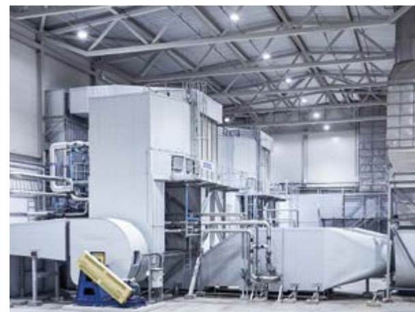
浆板干燥中的部分热回收系统
