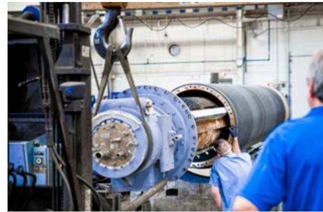
从真空辊上拆下吸水箱
