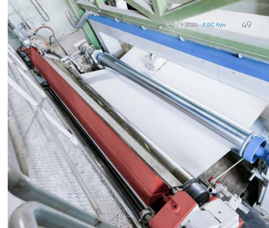
安德里茨提供的全新PrimeCal硬压光机在开机后很快达到了约定的平滑度标准。
