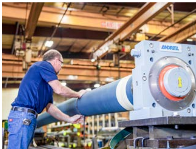
在测试台高速运转测试的完工弧形辊
