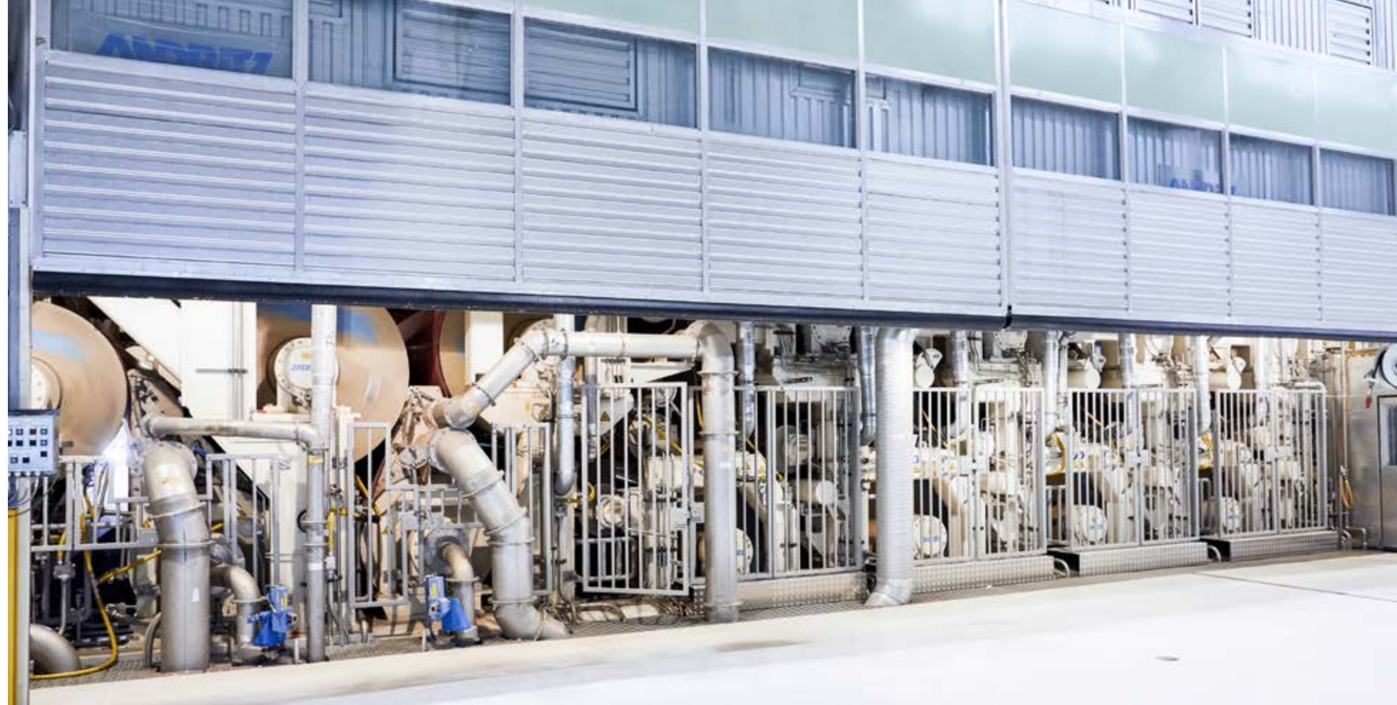
前干燥段和后干燥端都配有高效传热的钢制烘缸和确保纸页稳定运行的稳纸器。
