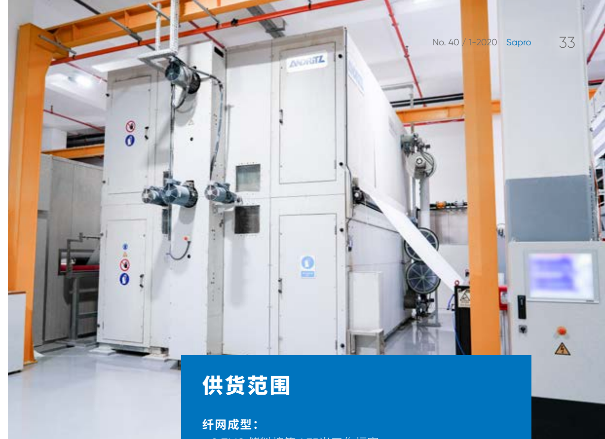
带热量回收功能的neXdry 烘干机
