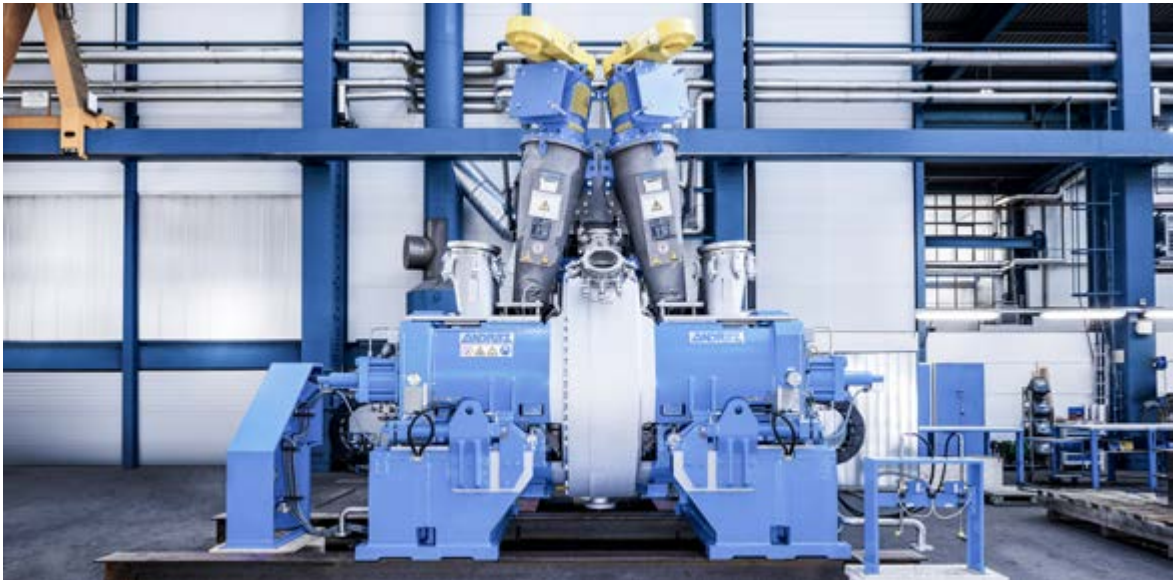
带有双SEPF (侧边料塞螺旋) 和C-Feeder (恒定进料螺旋) 的安德里茨TX68热磨机
