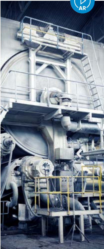
安德里茨优质的PrimeDry钢制扬克缸全部是由钢铁制成，相比于铸铁扬克缸，钢制扬克缸有助于提高安全性能以及提高8-10%的设备性能。
