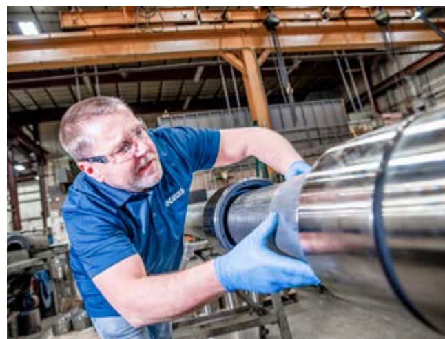
辊节组件装配过程中的金属面弧形辊
