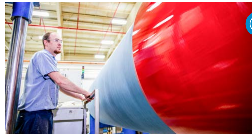
聚氨酯覆层的旋转浇注
