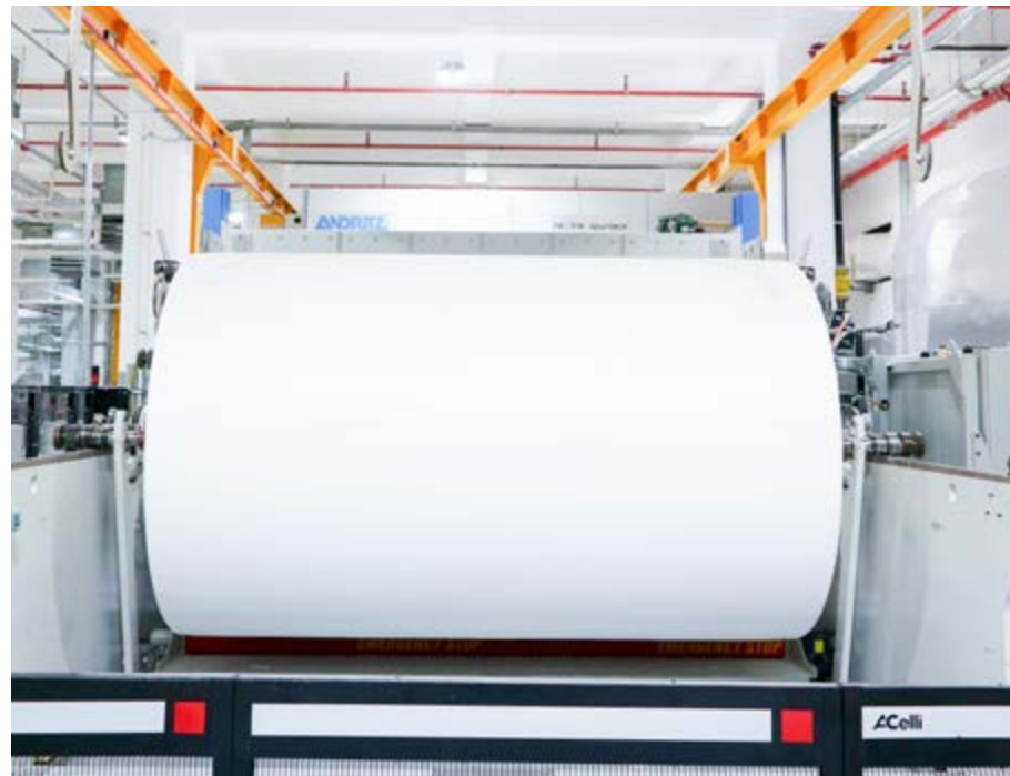
收卷设备：大卷可直接用于后续的分切生产线
