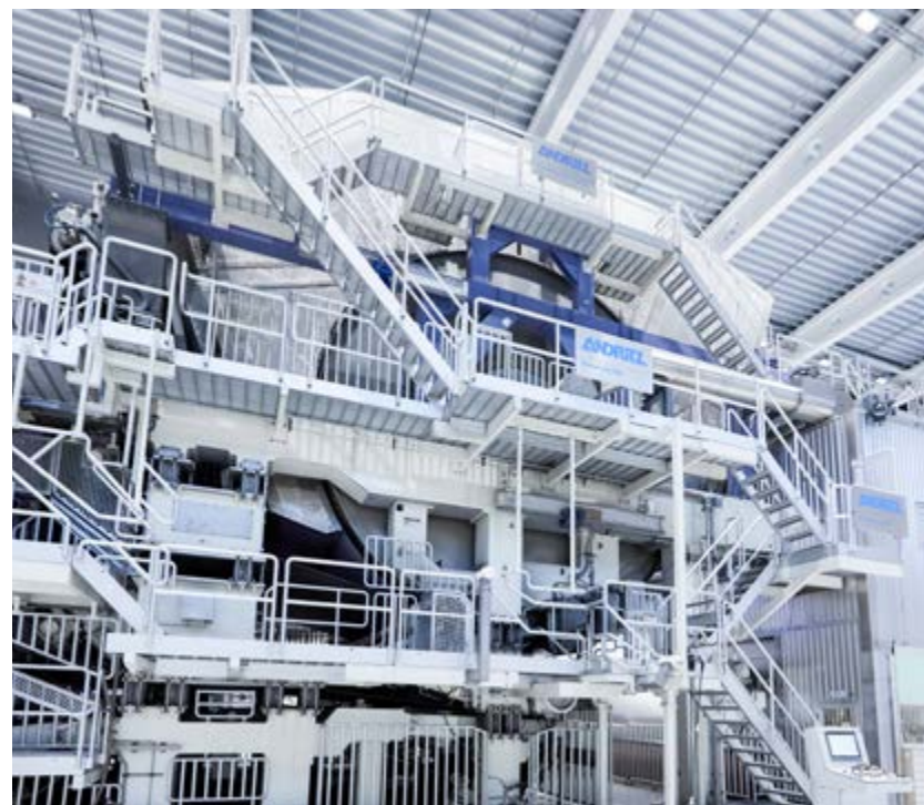
全球同类中尺寸最大的24英尺MG钢制扬克缸
