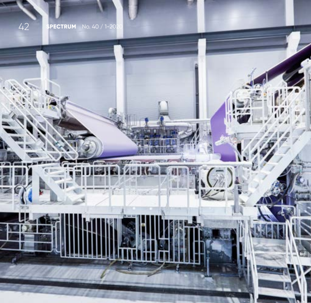
配有混合成型器的成型部
