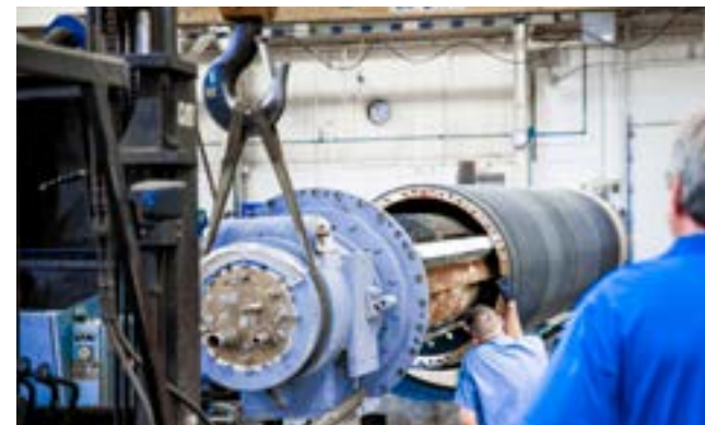
Отсасывающий ящик вынимается из отсасывающего вала
