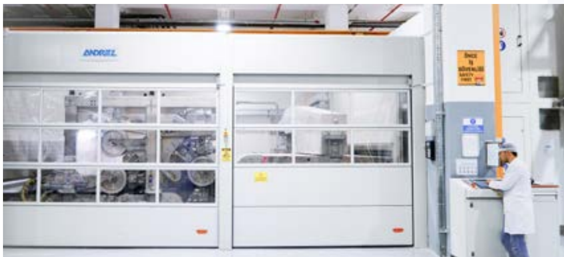
JetlaceEssentiel Устройство укрепления ворса водяной струей с современным инжектором neXjet
