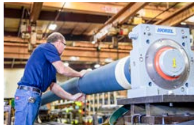
Подготовленный разгонный валик на высокоскоростной станции управления
