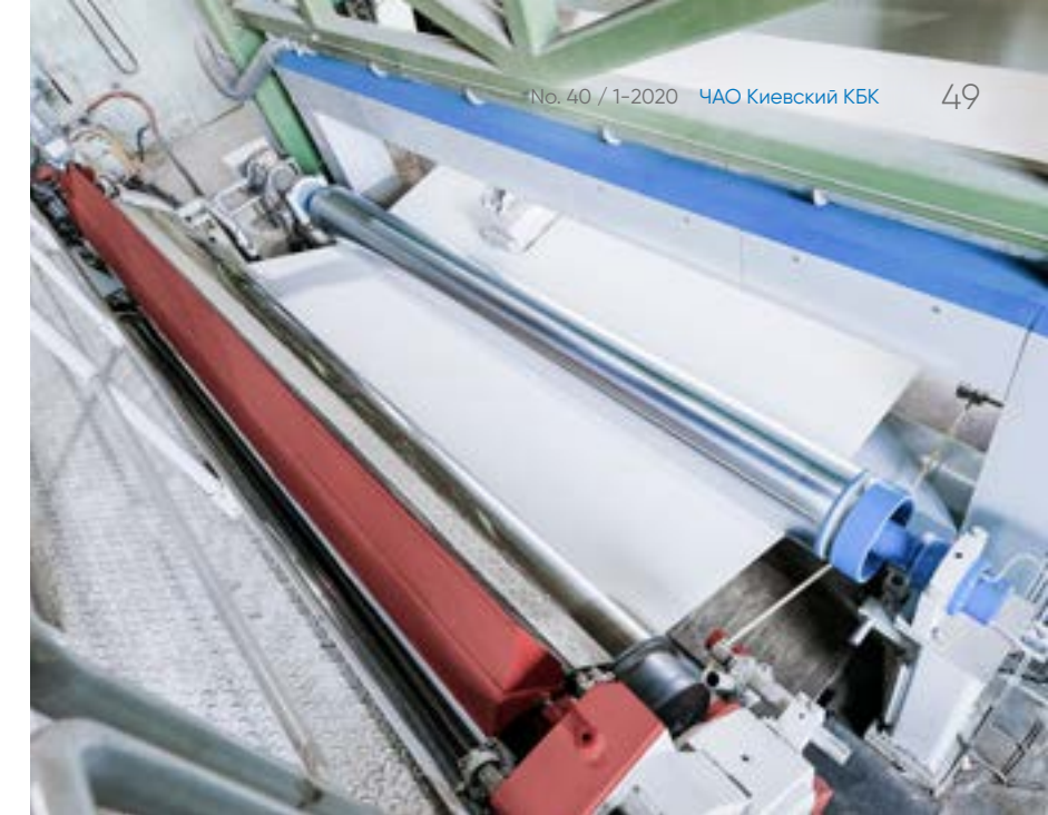
Новый каландр с твердым ззором PrimeCal от ANDRITZ достиг положенного уровня шероховатости вскоре после пуска.
