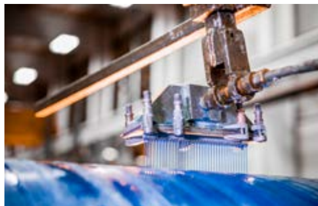
Производство облицовки вала из композитного материала
