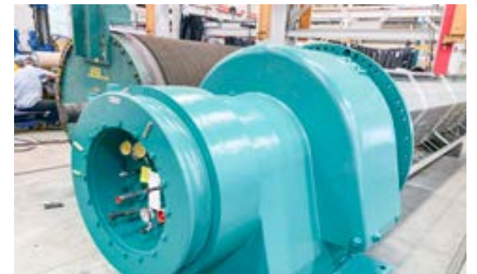
Отсасывающий ящик после восстановления
