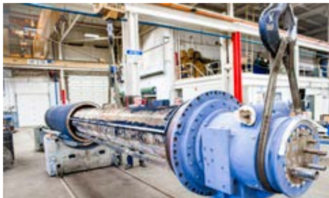
Отсасывающий ящик вынут из отсасывающего вала
