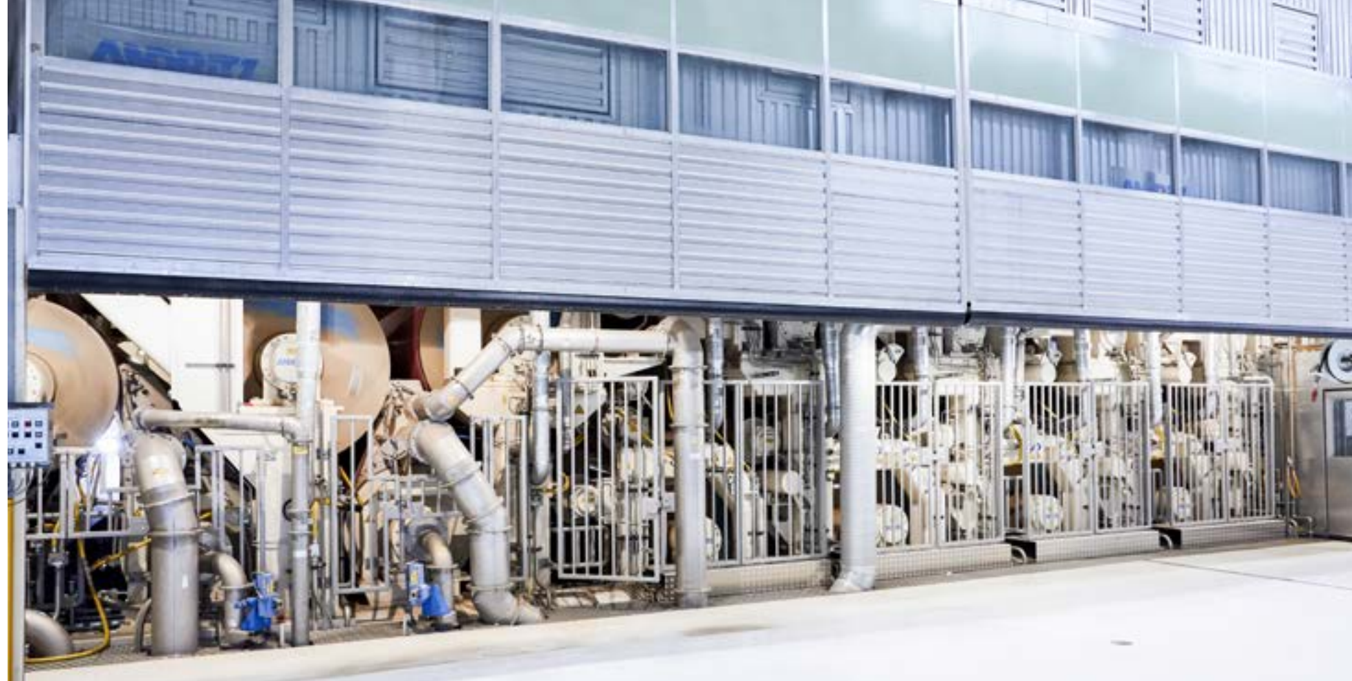
Зона предварительной сушки и до и дополнительная сушильная часть оснащены стальными цилиндрами для эффективной теплопередачи и стабилизаторами полотна для стабильного хода бумаги.
