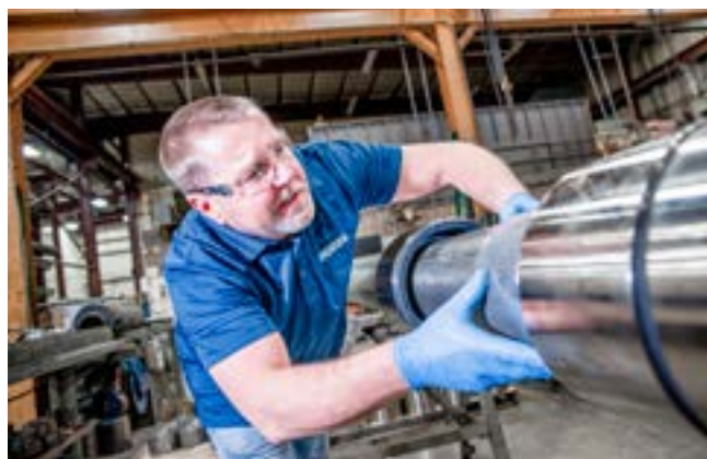
Металлический разгонный валик во время сборки тамбура наката
