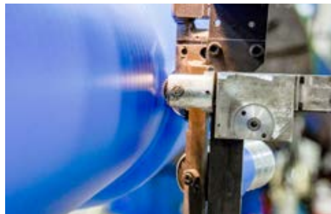
Производство облицовки вала с резиновым покрытием
