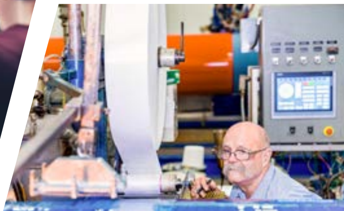
Производство облицовки вала из композитного материала
