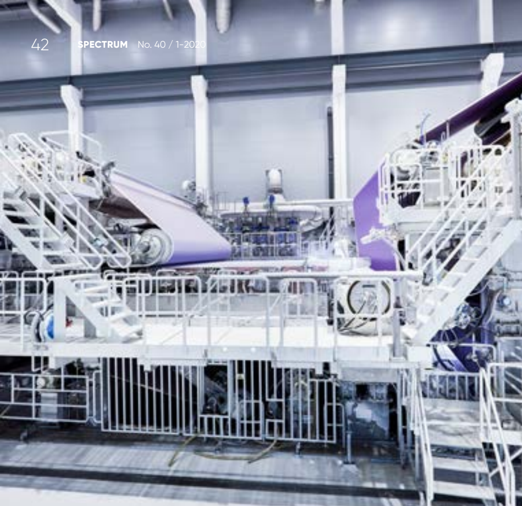
Формующая часть оборудована гибридным формующим устройством.
