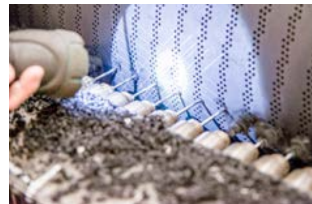
Процесс высверливания отверстий на облицовке вала
