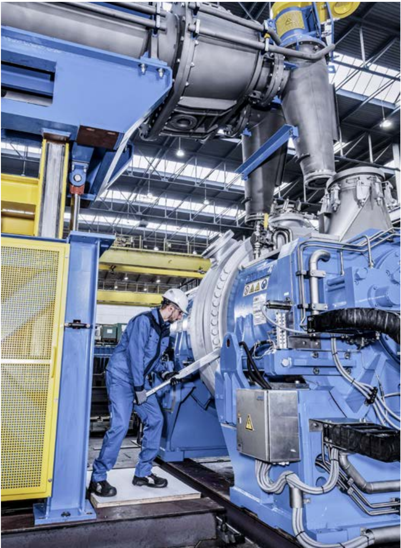
Система загрузки поднята для того, чтобы открыть сдвоенный рафинер
