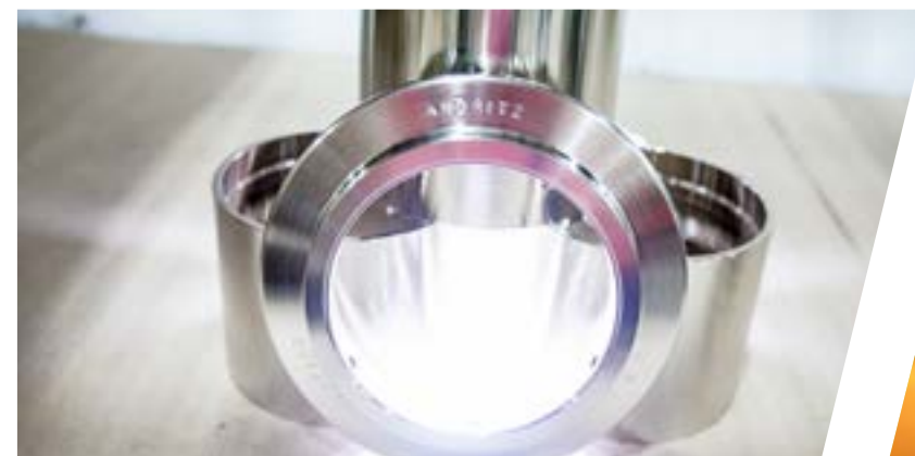
Компоненты разгонного валика, разработанные на заказ, после обработки на станке с ЧПУ типа CNC и никелирования
