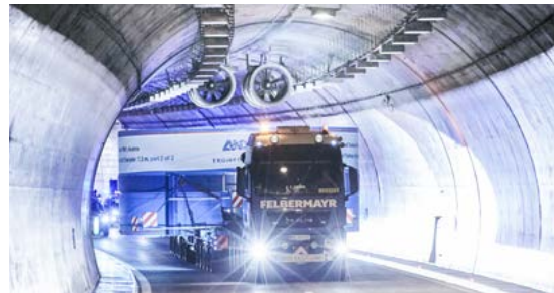
На основании уникальной технологии проектирования и логистической концепции ANDRITZ, Янки-цилиндр был транспортирован в виде двух половин и собран на месте установки.
