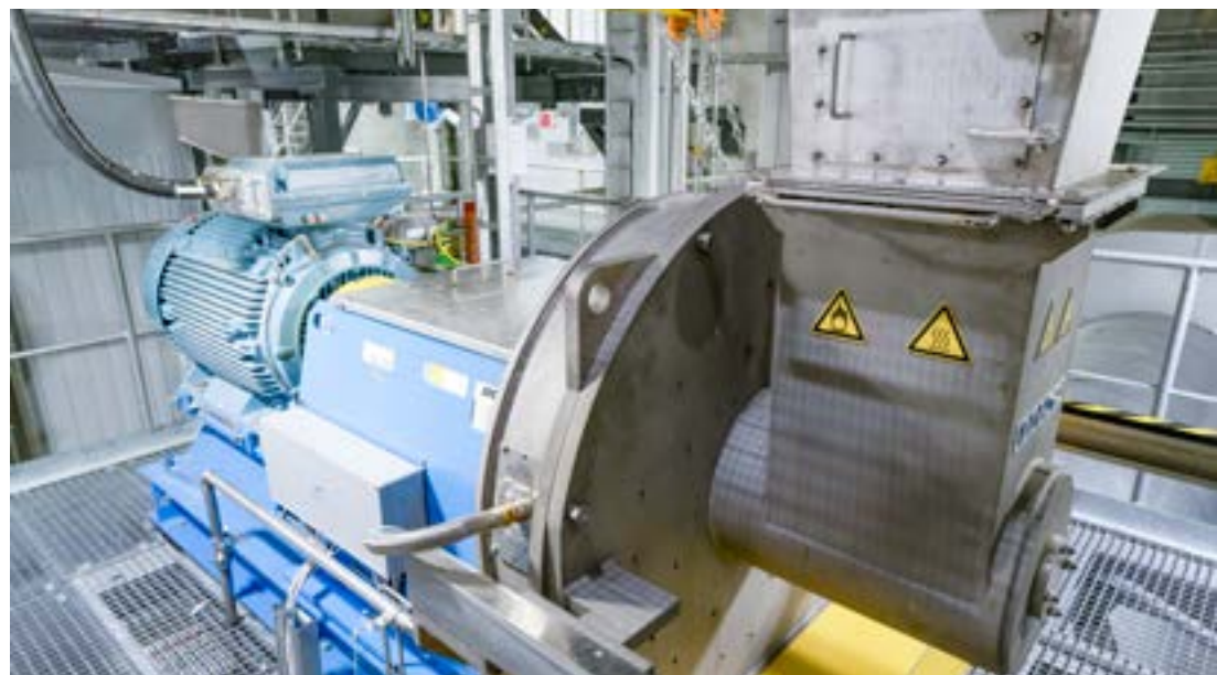
Разрыхлитель HC-Fluffer разбивает частицы волокна. Измельченная масса хорошо подготовлена для дальнейшего процесса сушки.
