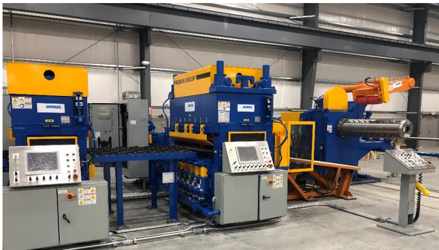
Eingangsseite der Querteilanlage mit Abhaspel und zwei Precision Leveler
