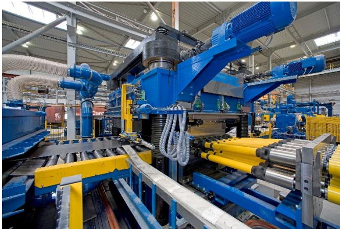
Hochleistungsrichtmaschine für ultrahochfeste Stähle
