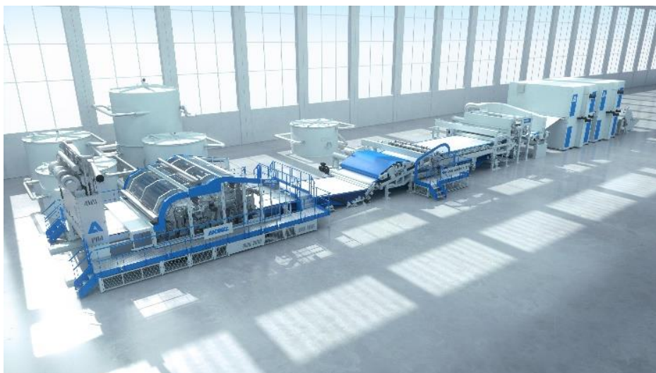
ANDRITZ neXline wetlace CP für die Produktion von biologisch abbaubaren Feuchttüchern
