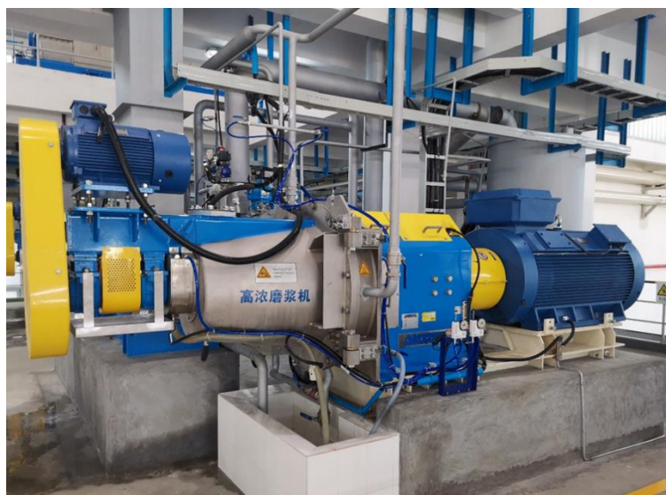
安装在维达阳江工厂的安德里茨高浓磨浆机
