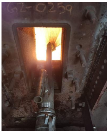
Erste Feuerung mit Schwarzlauge bei KR Pulp & Papers Limited
