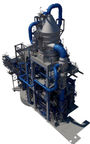
Renderização 3D da unidade de recristalização de cinzas (ARC)
