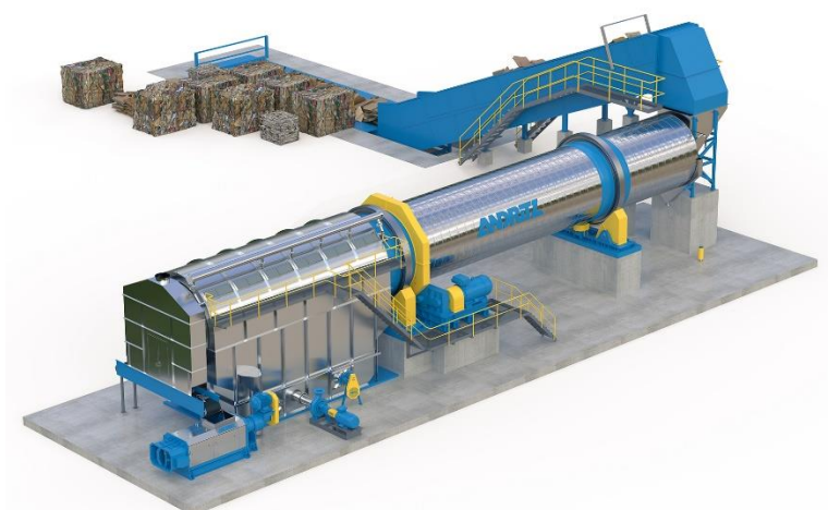
向玖龙纸业供货的第三条OCC浆线中配备的转鼓碎浆系统
