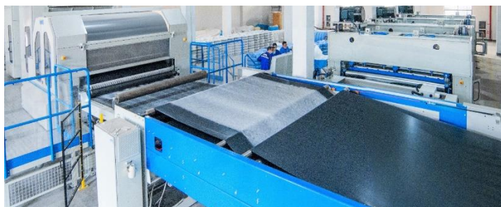
ANDRITZ-Nadelvlieslinie in Betrieb bei Yanpai Filtration Technology in Tiantai, China
