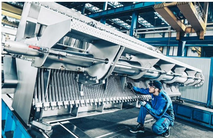
PrimeFlow AT- (Accelerating Tube) Stoffauflauf im Werk von ANDRITZ in Graz, Österreich
