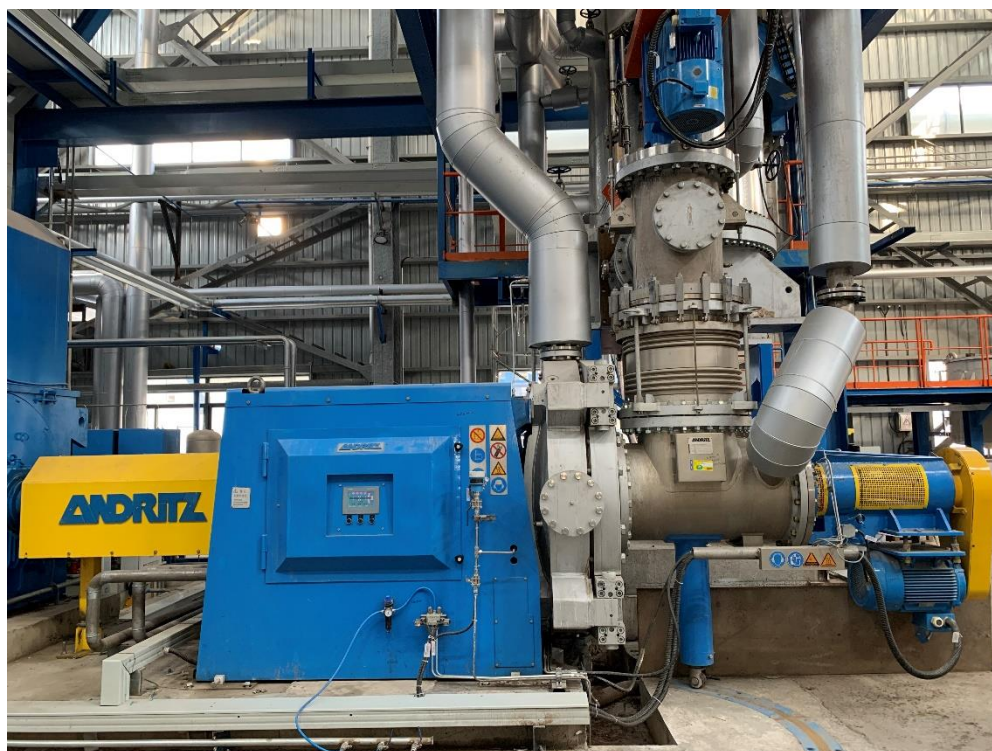
带压热磨系统的核心——安德里茨1CP热磨机
