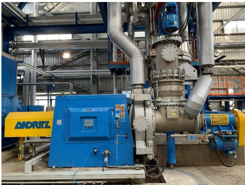
ANDRITZ 1CP Refiner als Herzstück der Druckzerfaserungsanlage
