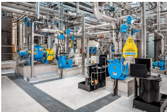
Auf der rechten Seite gezeigt: ANDRITZ-DeFlaker für optimale Zerkfaserung
