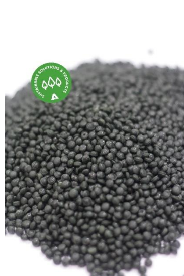
Endprodukt – Kunststoffgranulat, das am Ende des Prozesses entsteht
