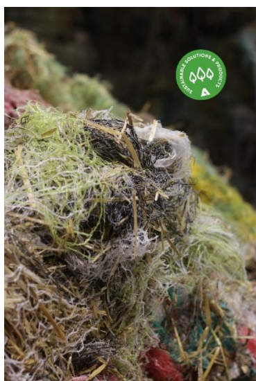
Netzabfälle vor dem mechanischen Reinigungsprozess
