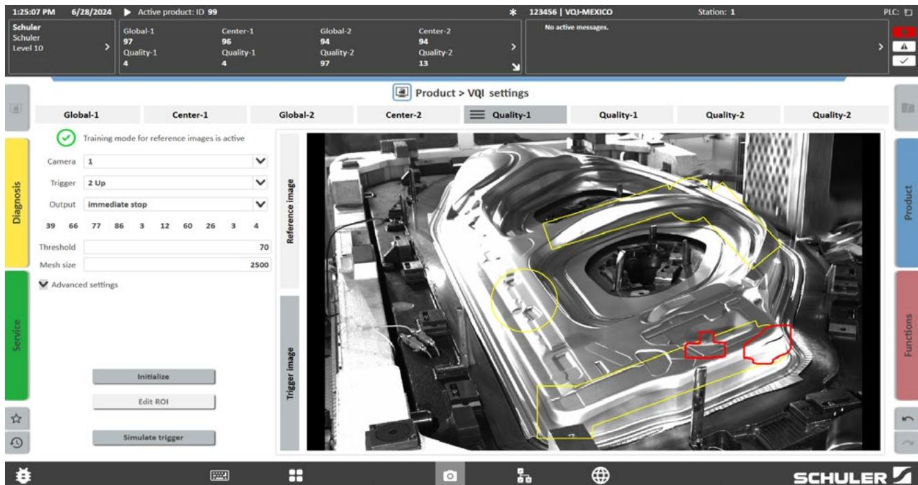
Der Visual Die Protection Analyzer ermöglicht detaillierte Einblicke in die Fehlerhistorie, auch im Remote-Einsatz.
