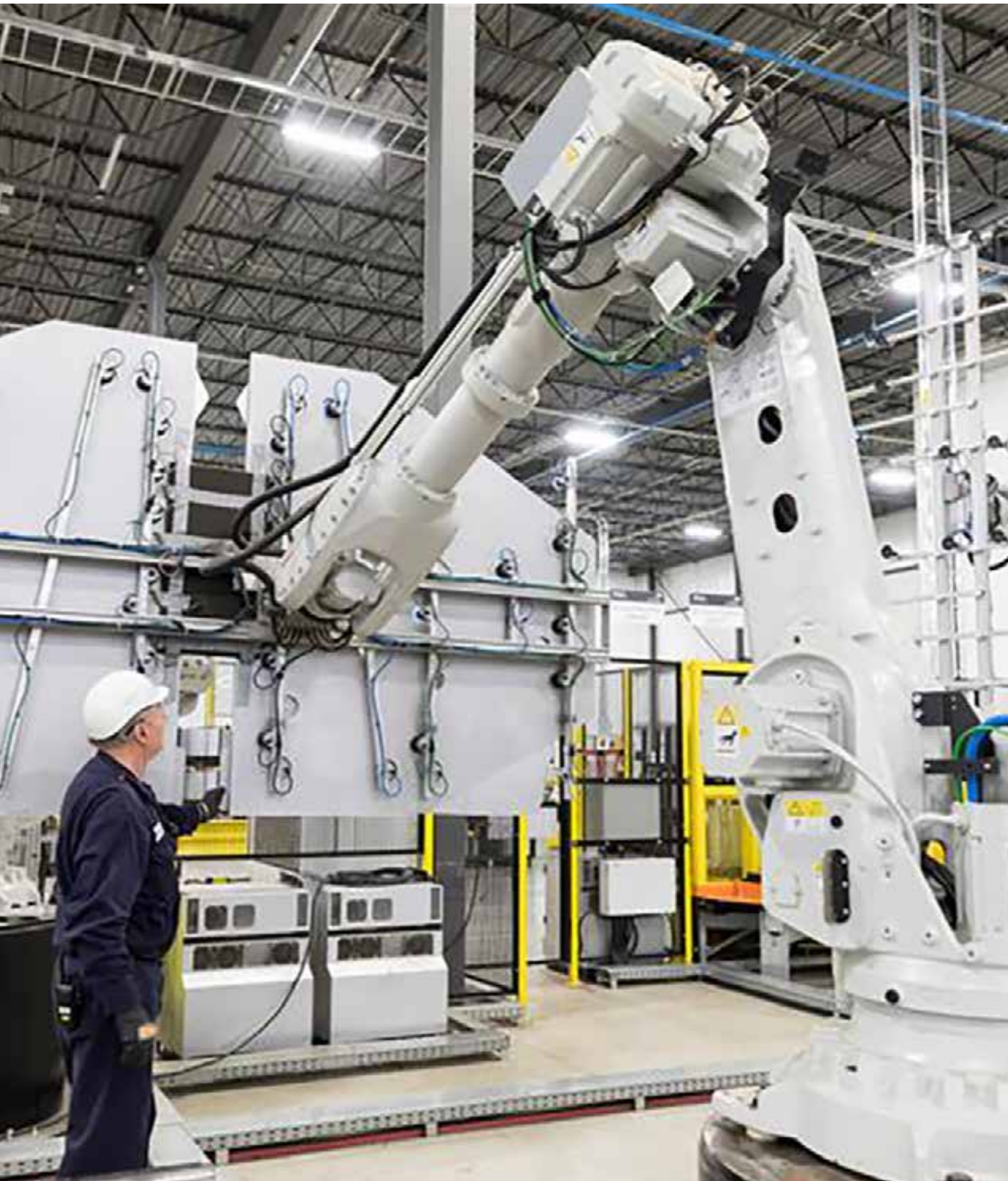
Mithilfe des SOURING-Laserschweißsystems von ANDRITZ produziert ArcelorMittal Door Rings für Fahrzeuge, die dank innovativer maßgeschneiderter Platinen um bis zu 30% leichter sind.
