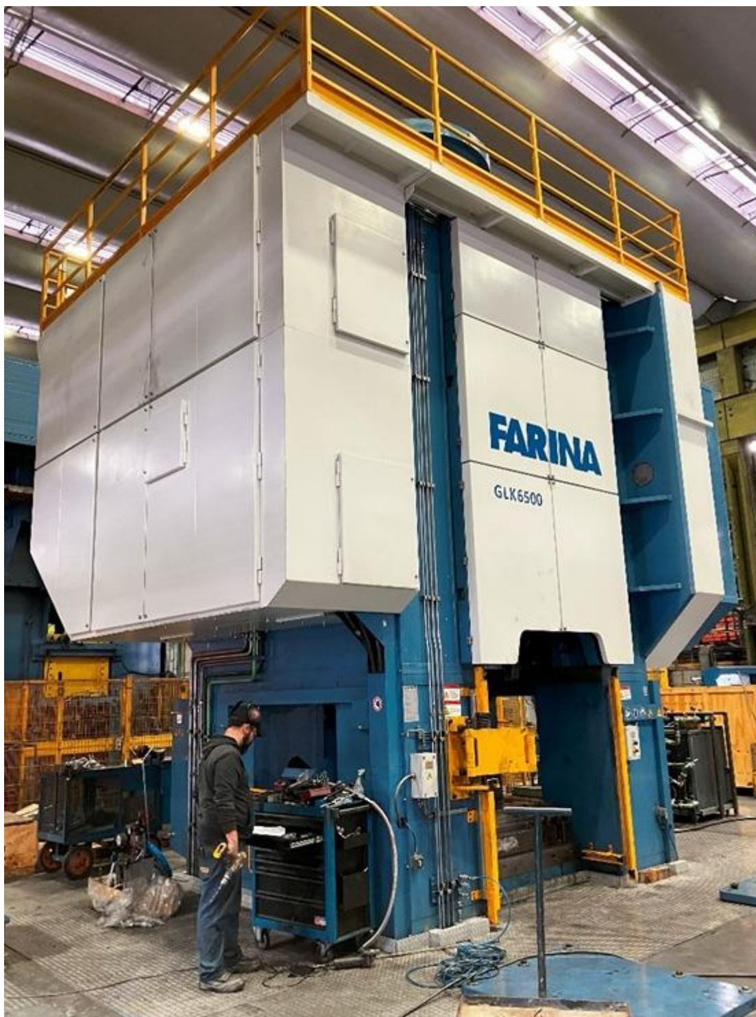
Die Presse des Typs GLK 6500 wurde von der italienischen ANDRITZ-Schuler-Tochter ANDRITZ Farina entwickelt und komplett am Standort Prensas Schuler in Brasilien errichtet.
