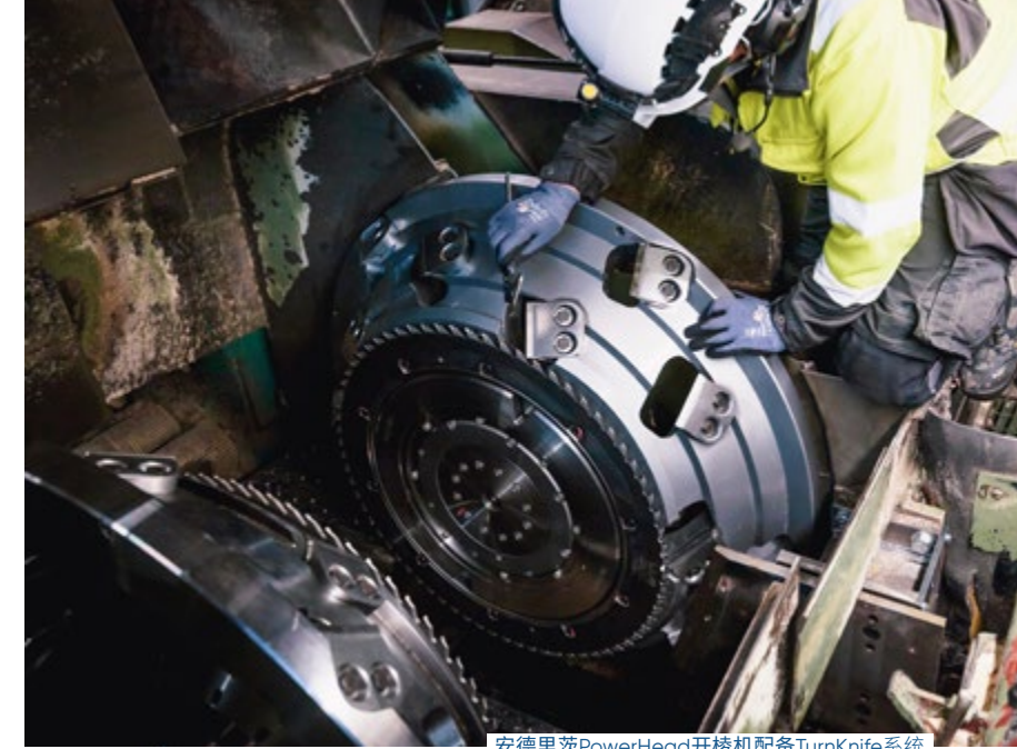
安德里茨PowerHead开棱机配备TurnKnife系统
