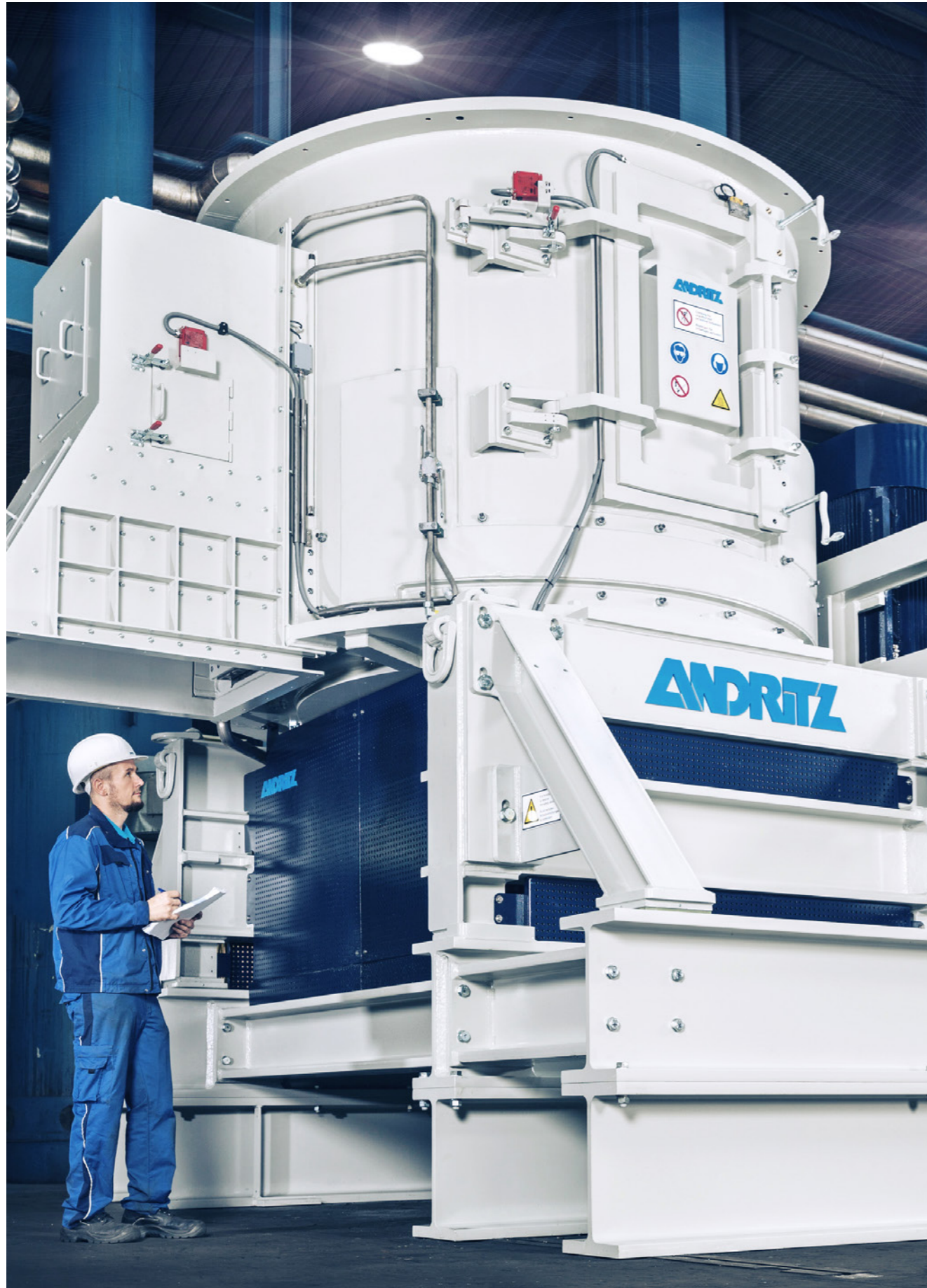
Endabnahme des ADuro QZ Shredders in der Fertigung
