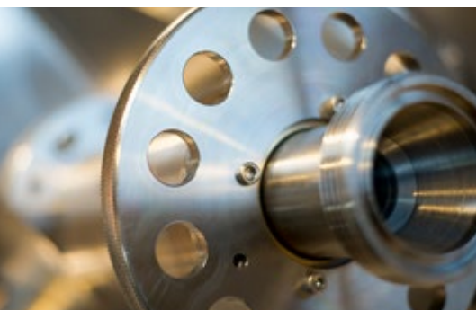
▲ Particolare del sistema di scarico della fase liquida
